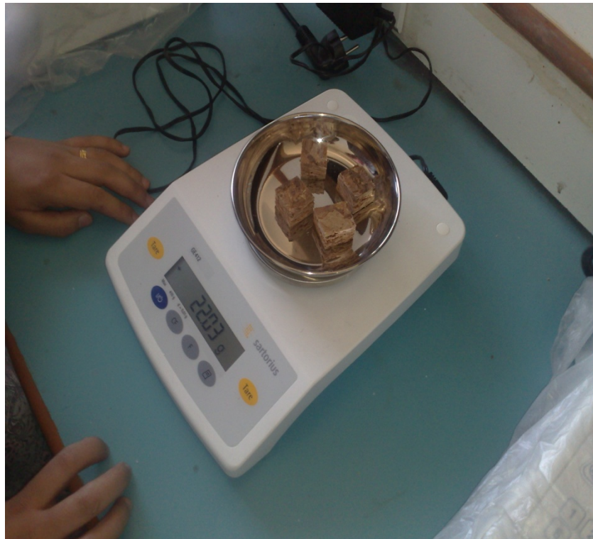
الشكل رقم (26) وزن العينات لاختبار الرطوبة.
