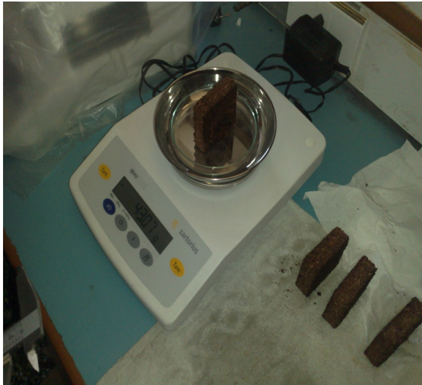
الشكل رقم (34) وزن العينات لاختبار الامتصاص.
