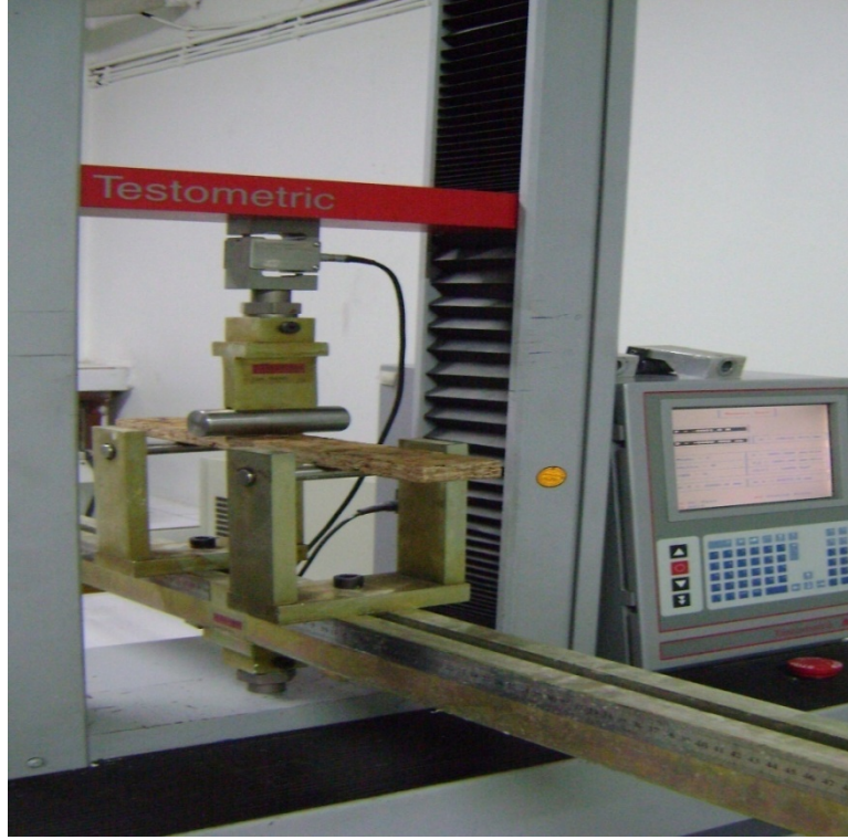
الشكل رقم (37) اختبار الانحناء الساكن.
