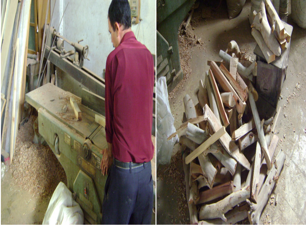
الشكل رقم (3) تحويل الفروع إلى رقائق نشارة خشبية باستخدام الرابوب
