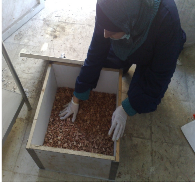
الشكل رقم (13) فرش النشارة المغرأة ضمن الإطار الخشبي
