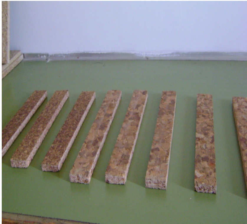
الشكل رقم (36) العينات المستخدمة في اختبار الانحناء الساكن.
