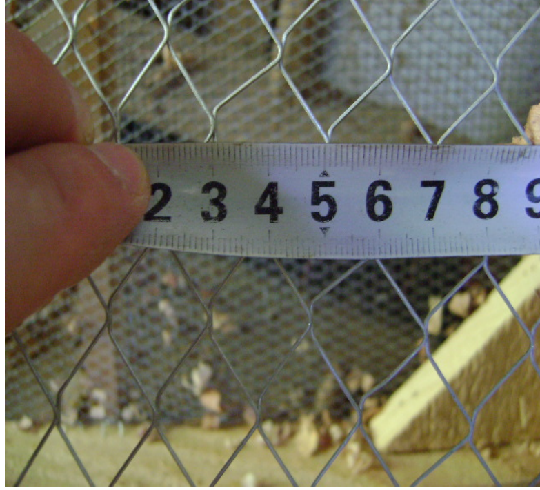
الشكل رقم (5)-منخل 2 سم للحصول على النشارة الكبيرة الحجم فوقه
