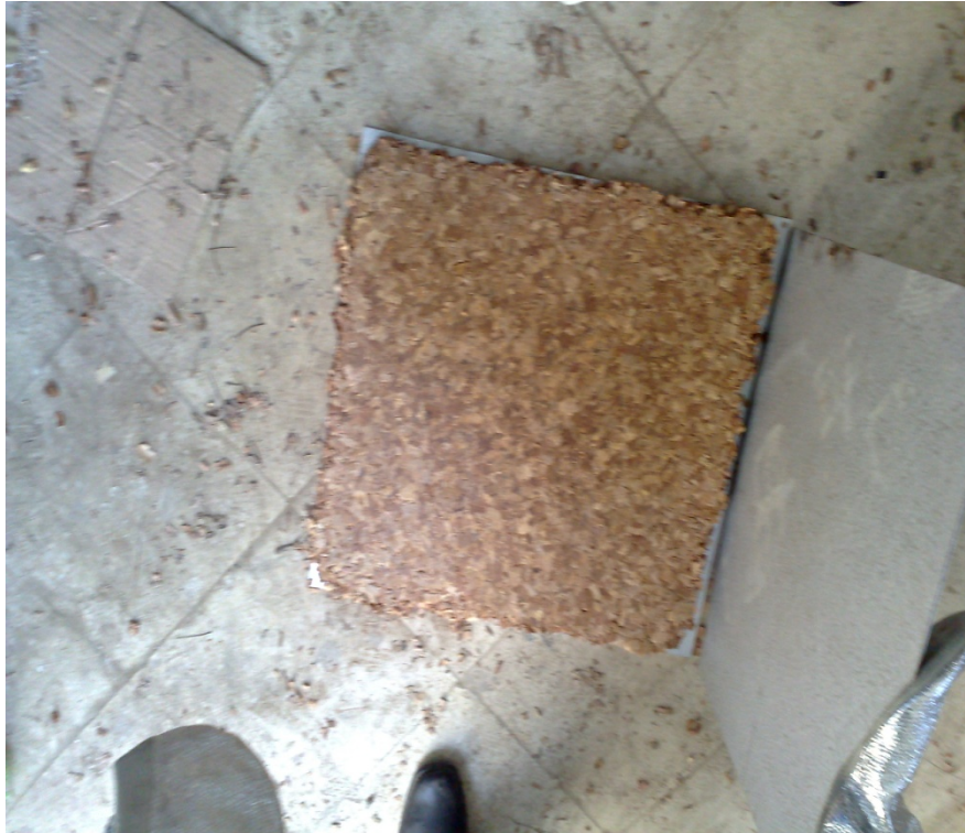
الشكل رقم (18) تبريد اللوح الخشبي بعد الكبس
