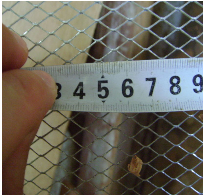
الشكل رقم (6) المنخل 1 سم للحصول على النشارة متوسط الحجم فوقه
