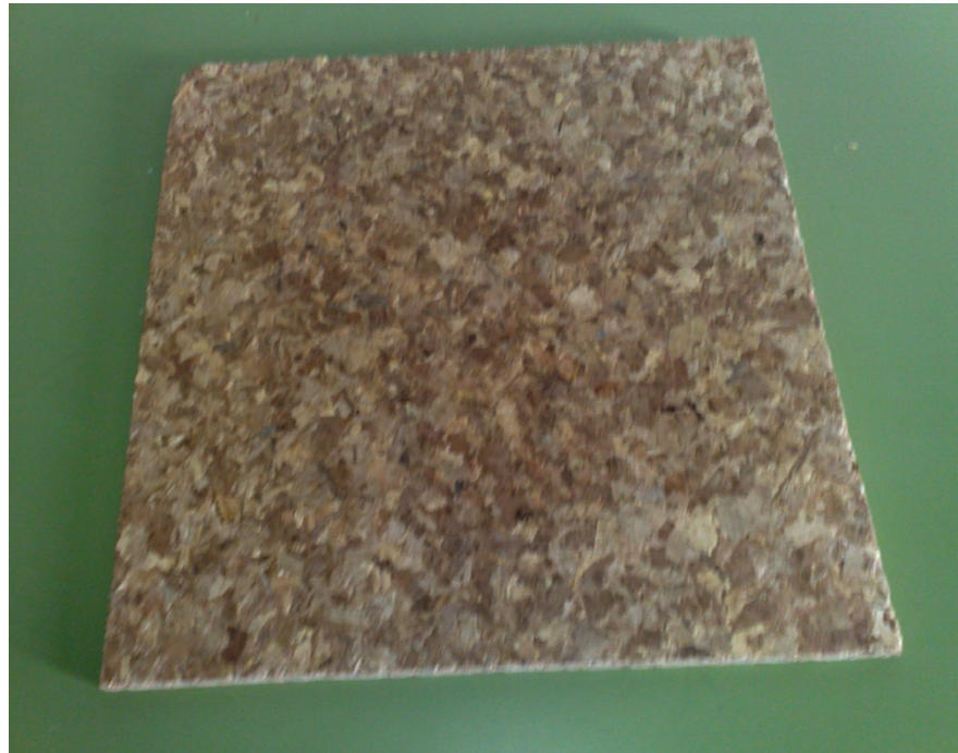
الشكل رقم (22) نموذج لوح خشبي مضغوط (8%، وسط).
