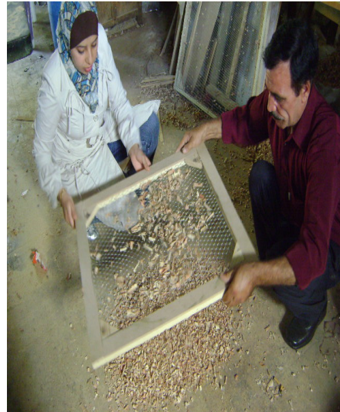
الشكل رقم (4) غربلة النشارة الخشبية لفصلها إلى أحجام مختلفة
