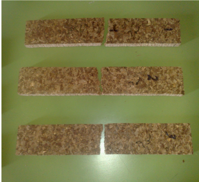
الشكل رقم (38) عينات الانحناء الساكن بعد الاختبار.
