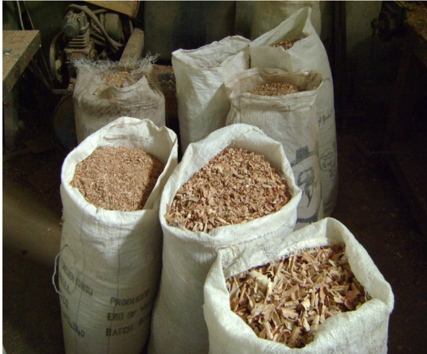
الشكل رقم (8) أحجام النشارة الخشبية المختلفة بعد الغربلة
