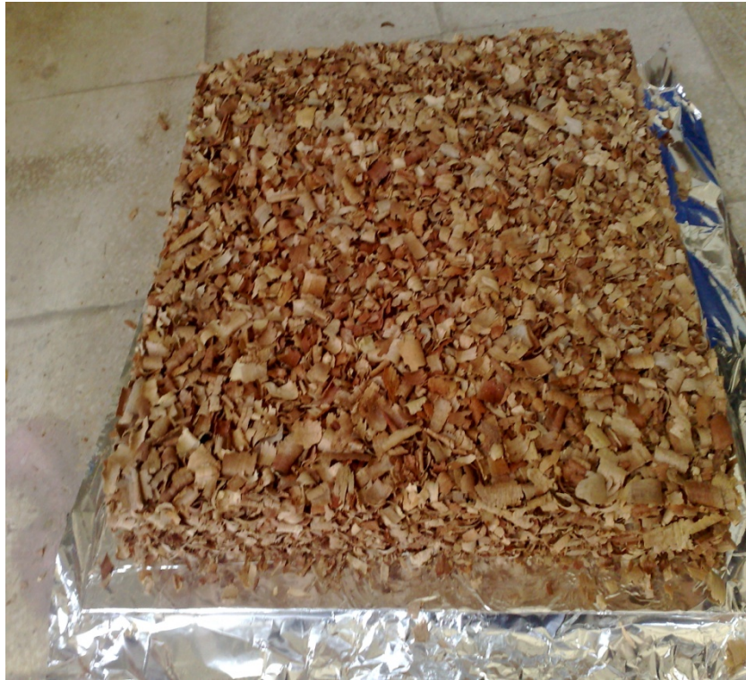
الشكل رقم (16) - فرشاة النشارة الخشبية بعد الكبس الأولي
