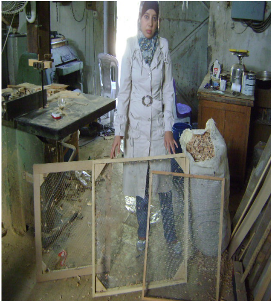
الشكل رقم (4) غربلة النشارة الخشبية لفصلها إلى أحجام مختلفة
