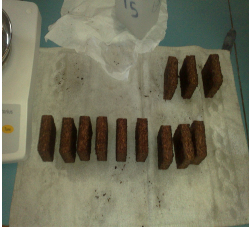
الشكل رقم (33) تجفيف العينات الخشبية بعد إخراجها من أحواض النقع.
