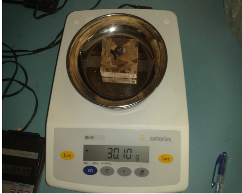
الشكل رقم (31) وزن العينات المستخدمة لاختبار الكثافة.
