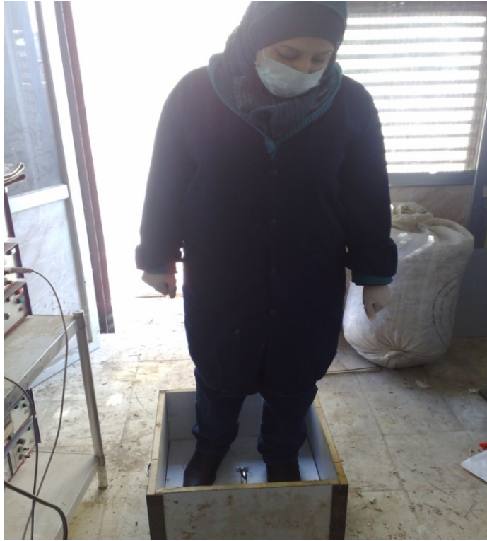
الشكل رقم (14) - كبس أولي للنشارة الخشبية المغرأة
