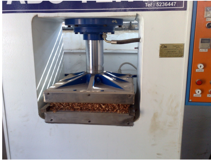
الشكل رقم (17) - كبس النشارة الخشبية بالمكبس الحراري
