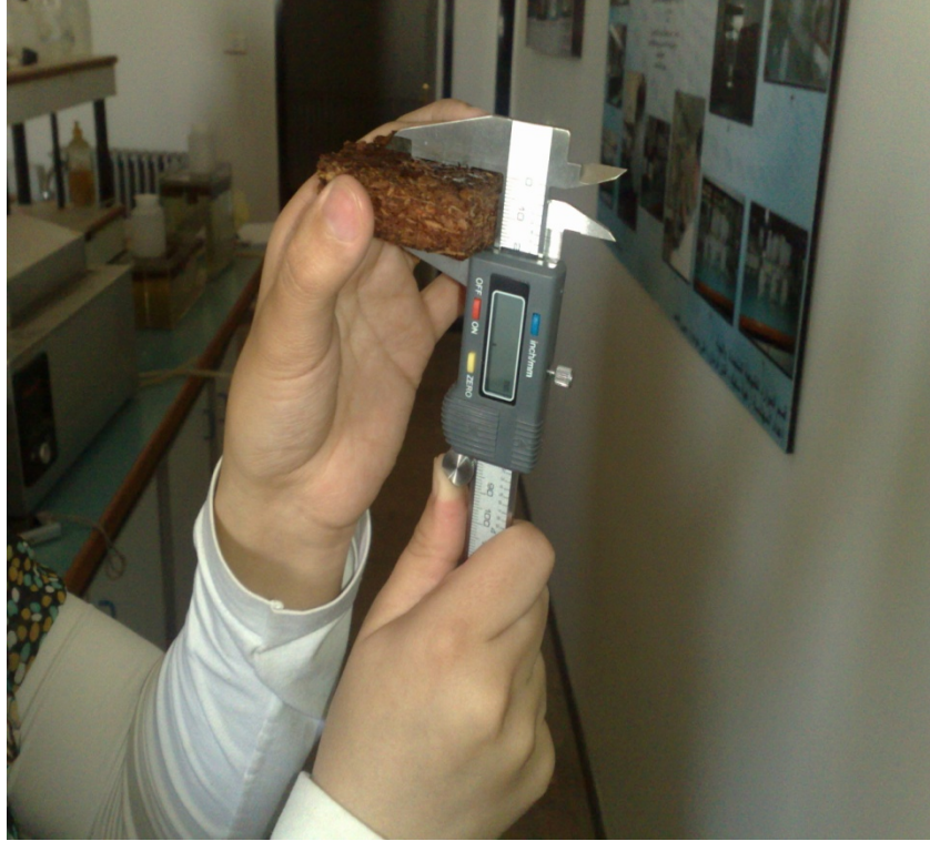
الشكل رقم (35) قياس أبعاد العينات الخشبية بعد النقع لاختبار الإنتجاج.
