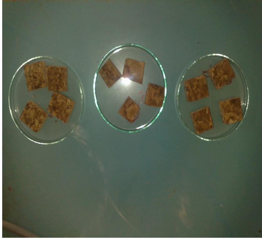
الشكل رقم (25) العينات المستخدم لاختبار الرطوبة.
