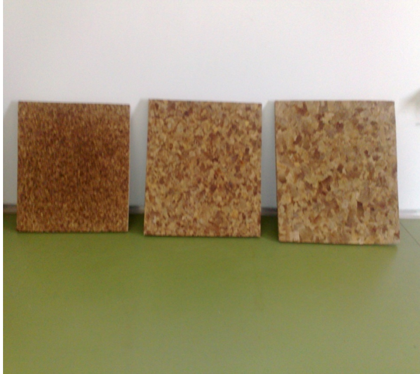
الشكل رقم (19) - تحديد حواف اللوح الخشبي بعد تبريده
