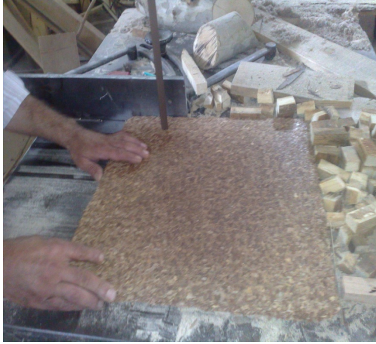
الشكل رقم (19) - تحديد حواف اللوح الخشبي بعد تبريده
