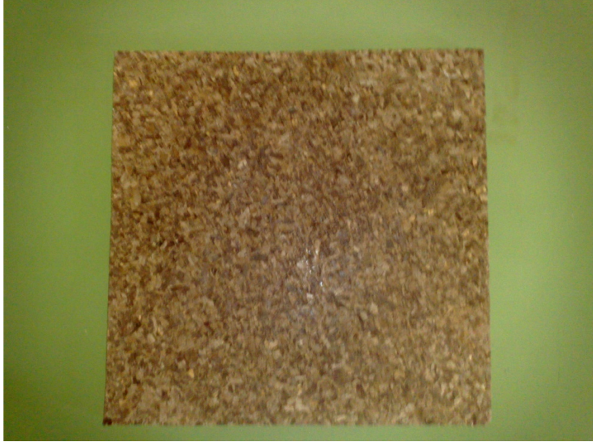
الشكل رقم (21) نموذج لوح خشبي مضغوط (10%، صغيرة).
