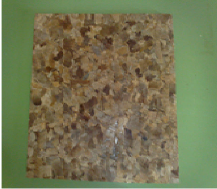
الشكل رقم (23) نموذج لوح خشبي مضغوط (12%، كبيرة).
