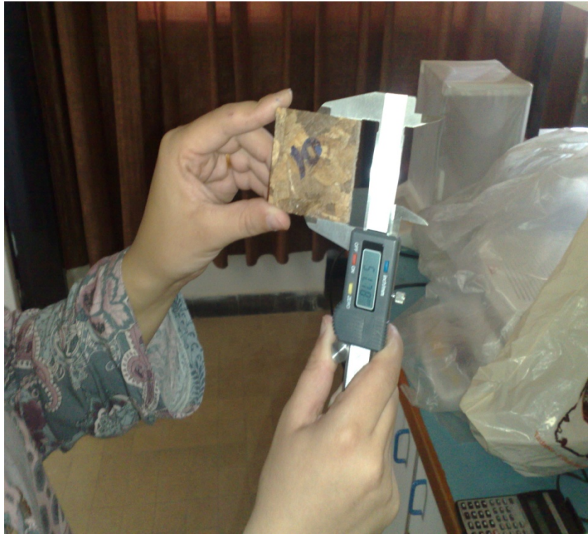
الشكل رقم (30) قياس أبعاد العينات الخشبية بالبياكوليس.
