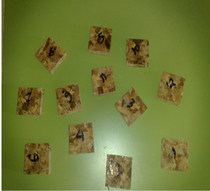
الشكل رقم (29) العينات المستخدمة لاختبار الكثافة ، الامتصاص ، الانتباج.
