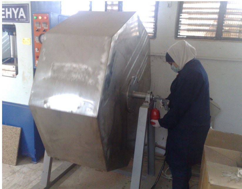
الشكل رقم (12) بخ المقسي على النشارة الخشبية ضمن الخلاط
