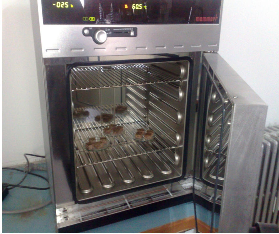
الشكل رقم (27) تجفيف العينات الخشبية لاختبار الرطوبة.
