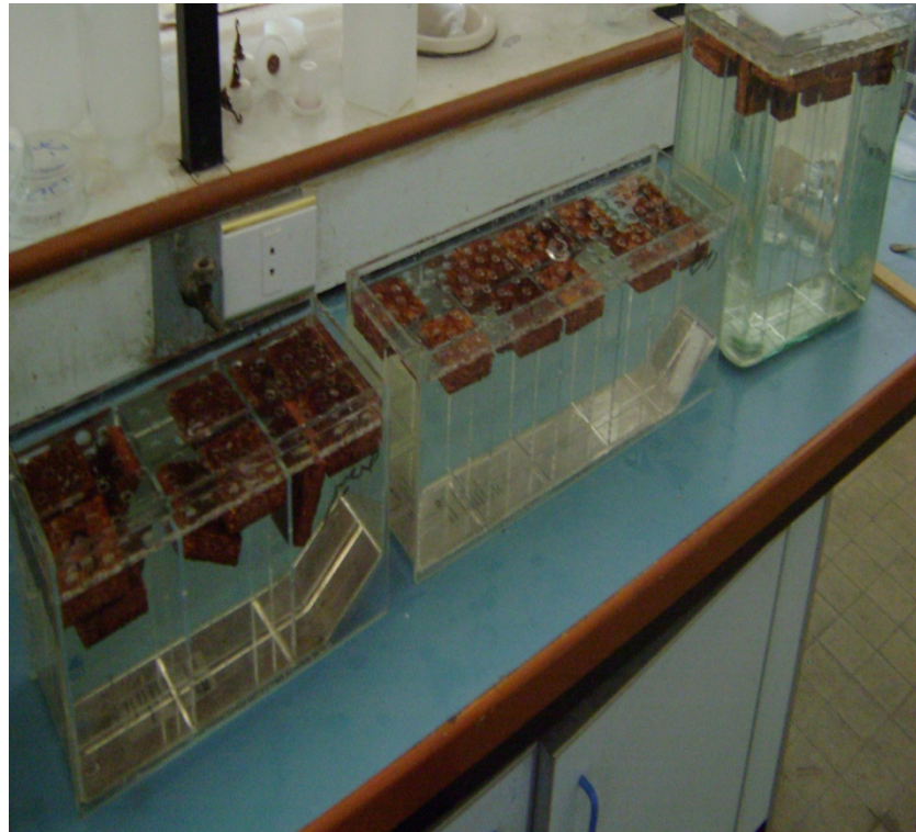
الشكل رقم (32) وضع العينات الخشبية في أحواض النقع لاختبار الامتصاص والإنتباج.
