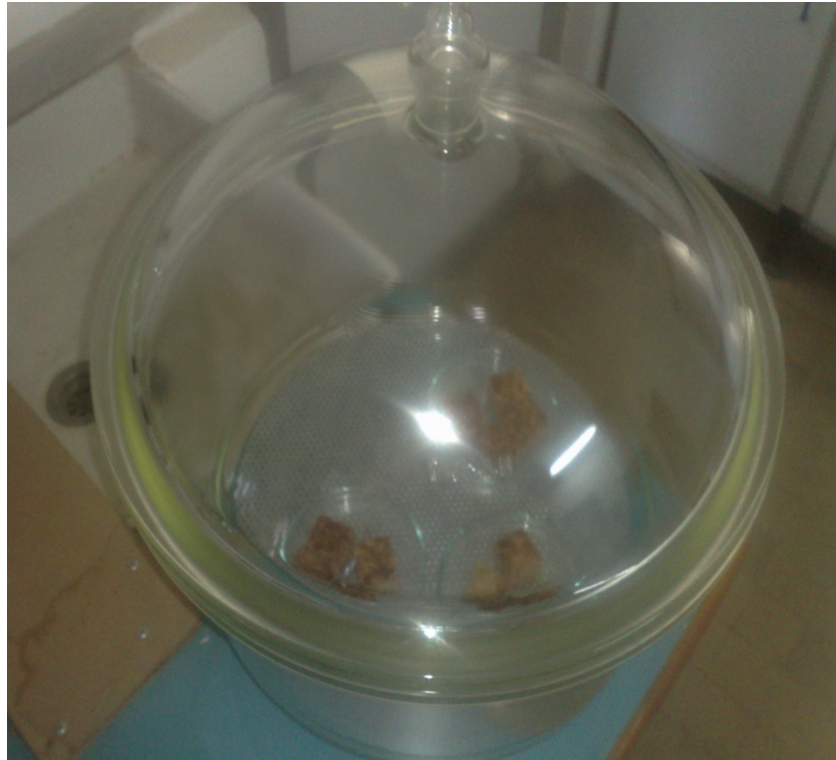
الشكل رقم (28) وضع العينات الخشبية في الديسسيكاتور.
