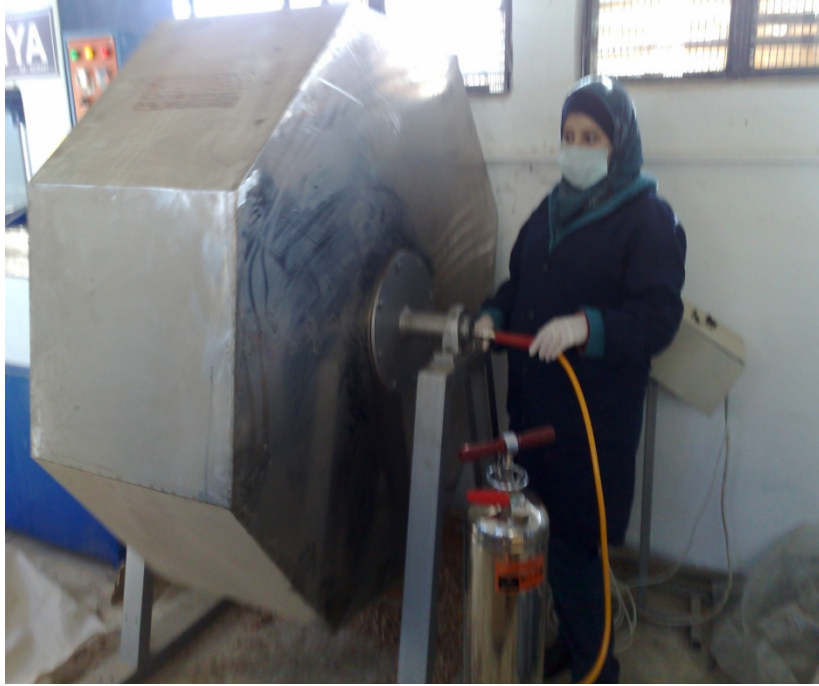
الشكل رقم (11)- بخ الغراء على النشارة الخشبية ضمن الخلاط
