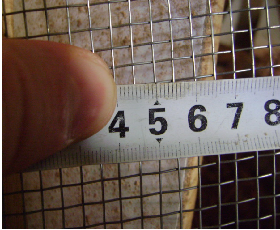
الشكل رقم (7) المنخل 0.5 سم للحصول على النشارة صغيرة الحجم فوقه
