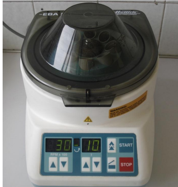
الشكل (16) جهاز تثفيل نوع Hettich المستخدمة في البحث
