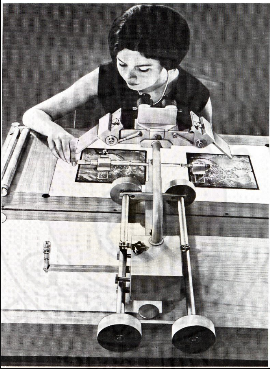
شكل (62): جهاز تفسير مجسم مزود بستيريوسكوب وستيريومتر ويمكن من تفسير الصور التي أبعادها 30×30 سم
