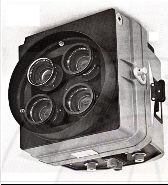
شكل (28): آلة تصوير ذات اللقطة متعددة العدسات تحوي مرشحات زرقاء، خضراء، حمراء وتحت حمراء
