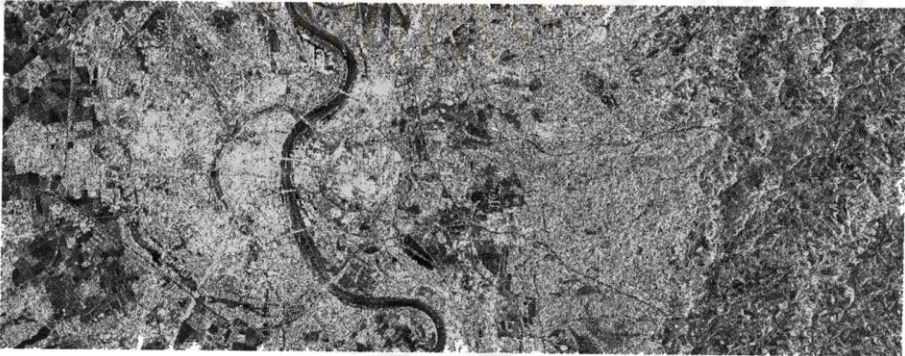
شكل (67): صورة رادارية ملتقطة بواسطة القمر الصناعي ERS عام 1992 لمدينة كولن ومحيطها في مجال الأشعة الميكروية ضمن المجال الطيفي 6 سم بمقياس 1:250000
