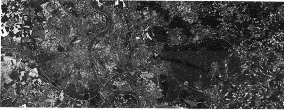
شكل (65): صورة ملتقطة بواسطة الماسح الغرضي المحمول على لاندسات عام 1992 لمدينة كولن ومحيطها في مجال الأشعة المرئية بموجة طولها 0.6-0.7 ميكرومتر ومقياس 1:250000
