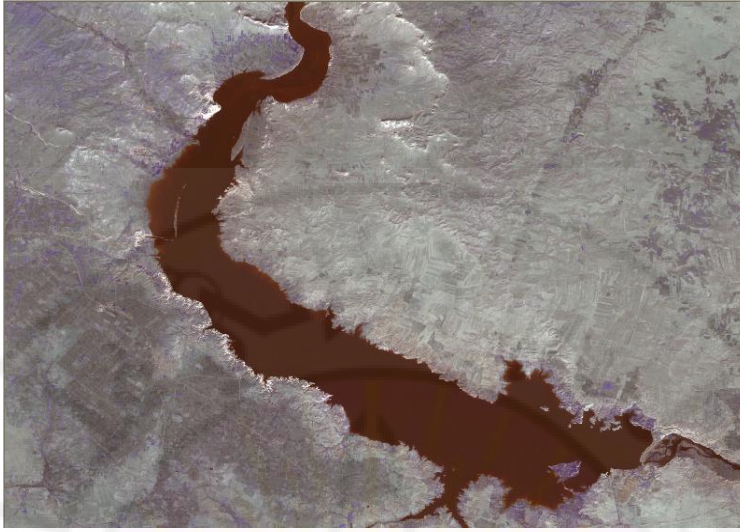
شكل (98): بحيرة الأسد ملتقطة بواسطة القمر الهندي IRS-LISS عام 2007 في المجالات الطيفية 2.3.4 بقدرة تمييز 24 متراً
