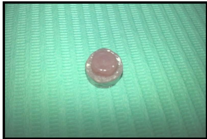
الشكل النهائي لعينات خليطة الكروم كوبالت (أسطوانتي المعدن والراتنج الأكريلي حراري التصلب بعد تحضير السطح والربط بينهما) (الشكل ٢٩) .
