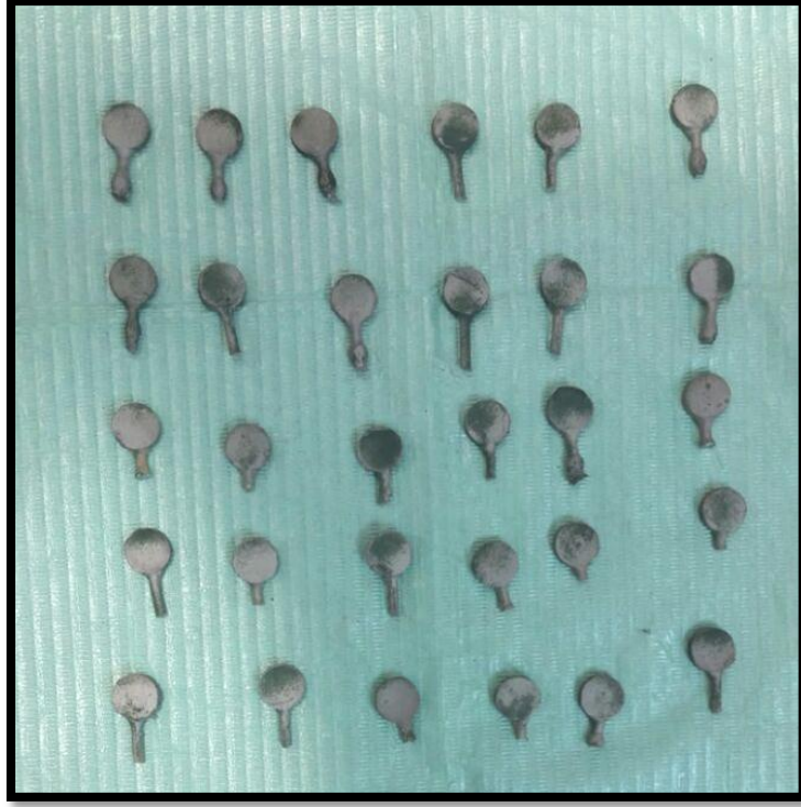
العينات المعدنية موصولة بأوتاد الصب بعد الصب والفصل ولا زالت بقايا المسحوق الكاسي عليها (الشكل ٢١) .
