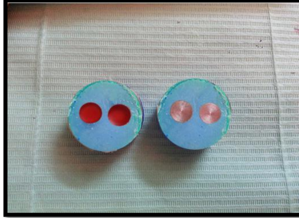
(الشكل ٦) النماذج المعدنية التي جرى نسخها
