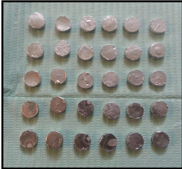
العينات المعدنية المصبوبة بخليطة الكروم كوبات بعد الإنهاء (الشكل ٢٢) .
