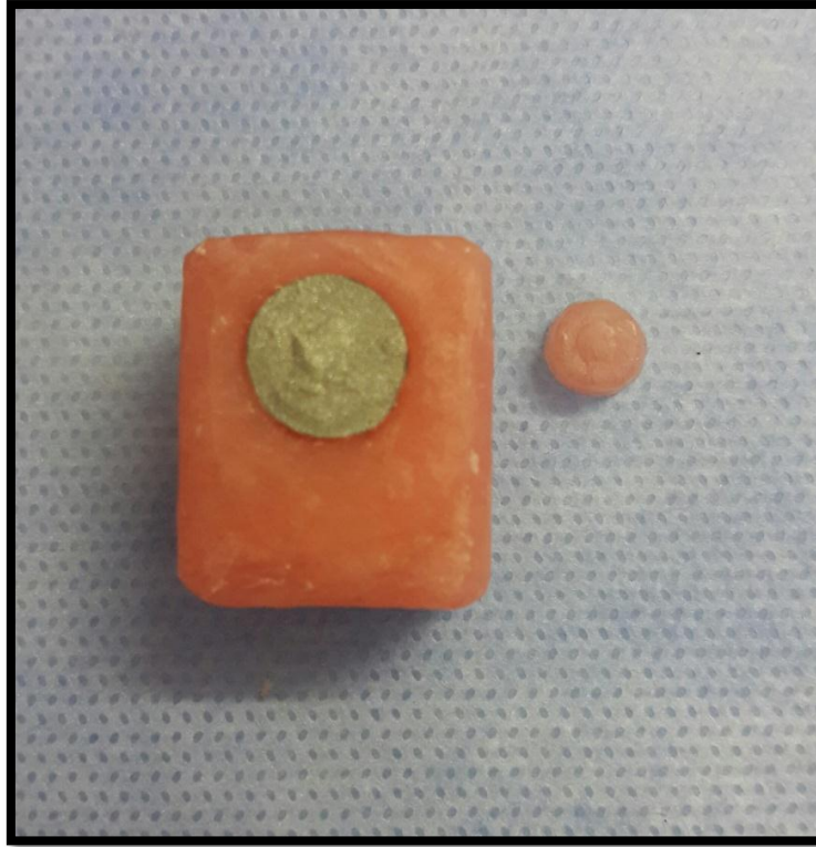
شكل العينة بعد حدوث الانفصال الكامل بين أسطوانتي المعدن والراتنج الأكريلي حراري التصلب (الشكل ٤٦)
