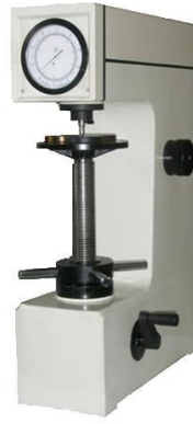
الشكل رقم (5.3): صورة فوتوغرافية للجهاز المستخدم بقياس القساوة ضمن البحث الحالي
