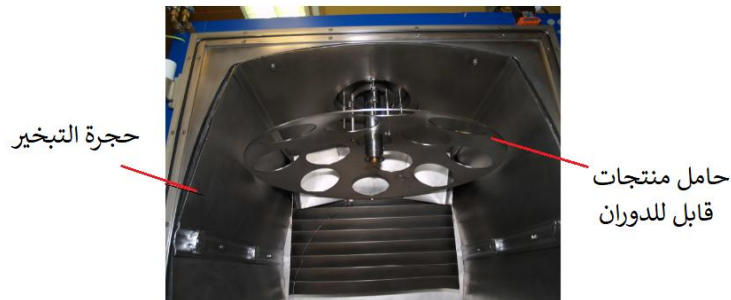
الشكل رقم (8.3): صورة توضيحية لتوضع حامل المنتجات الدوار ضمن حجرة التبخير
