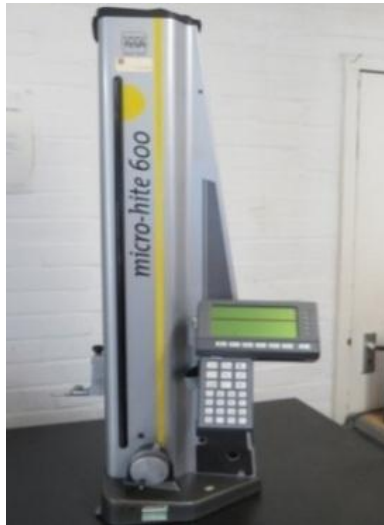
الشكل رقم (4.3): صورة فوتوغرافية لجهاز القياس الميكرومتر المستعمل بالبحث الحالي
