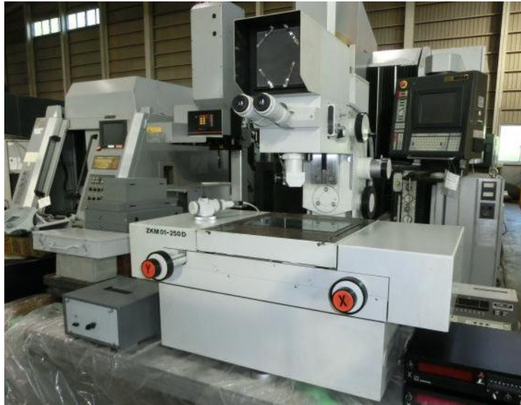
الشكل رقم (9.3): صورة لجهاز المقارن البصري المستعمل بالبحث
