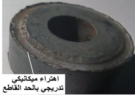
الشكل رقم (12.3): بيان لأنماط الانهيار الحاصلة بالحدود القاطعة
