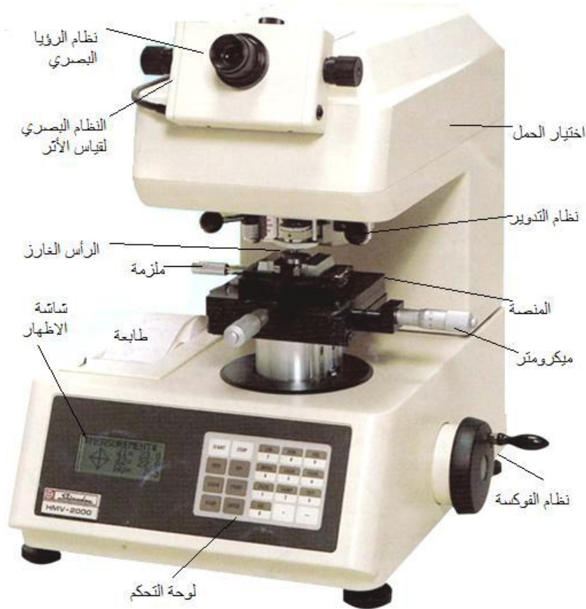
الشكل رقم (6.3): التفاصيل الشكلية لجهاز قياس القساوة الميكروية
