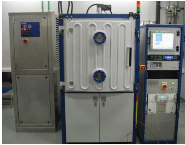
الشكل رقم (7.3): صورة فوتوغرافية للجهاز المستخدم بطلاء اللقم موضوع البحث الحالي
