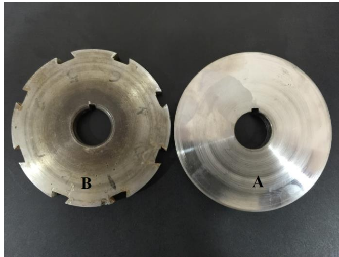
الشكل (12): (A) القرص المعدني الخاص بجهاز اختبار المواد على الاحتكاك، (B) القرص المعدني الخاص بالجهاز بعد تعديله
