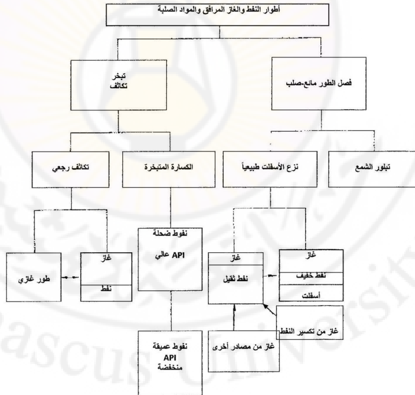
الشكل (4-9). تغيرات الطور المختلفة التي يمكن أن تحصل في الخزان.
