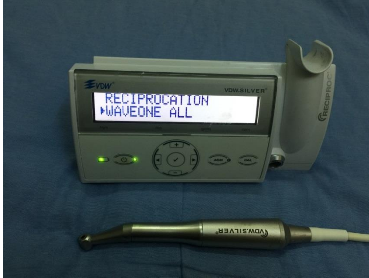
الشَّكْلُ رَقْم (17) يُبَيِّنُ جِهَازَ VDW.Silver حَيْثُ تَمَّ ضَبْطُهُ عَلَى إِعْدَادَاتِ نِظَامِ Wave One
