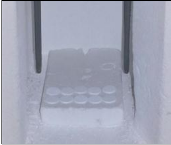
شكل 46: تليد الهياكل الزيركونية في فرن الإحماء المخصص
