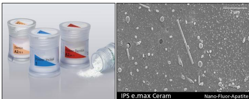
شكل 5: يوضح البنية المجهرية والشكل التجاري لخزف IPS-e.max Ceram (IvoclarVivadent)
