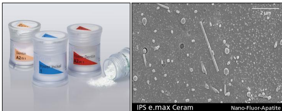
شكل 5: يوضح البنية المجهرية والشكل التجاري لخزف IPS-e.max Ceram (IvoclarVivadent)
