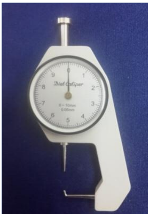
شكل 34: مقياس الثخانة المستخدم
