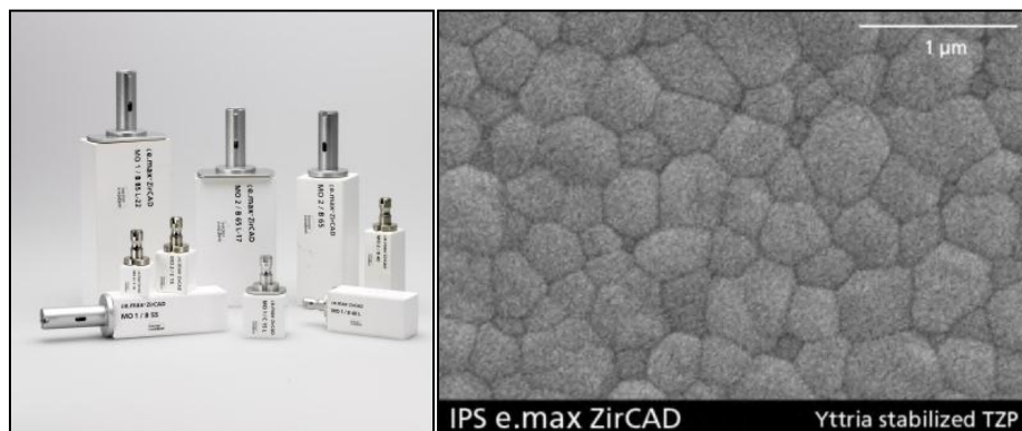
شكل 4: يوضح البنية المجهرية والشكل التجاري لخزف IPS-e.max ZirCAD (IvoclarVivadent)
