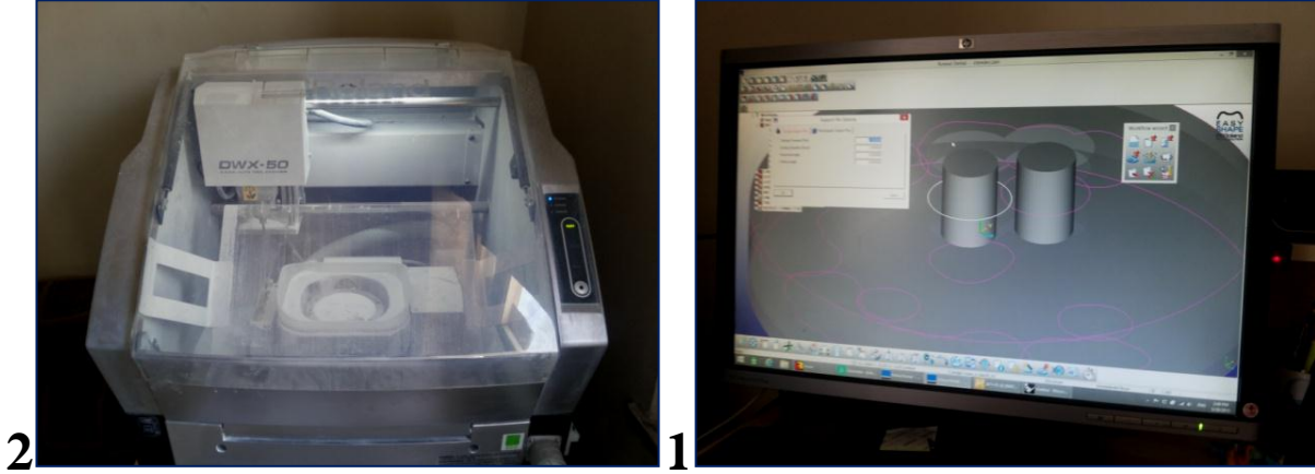
شكل 28: مكونات جهاز CAD/CAM: (1) جهاز الكمبيوتر مع برنامج التصميم (2) آلة النحت
