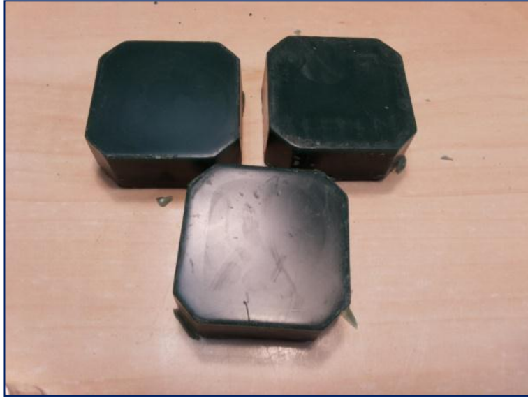
شكل 22: شمع الصب المستخدم لتشميع أقراص المجموعة الأولى
