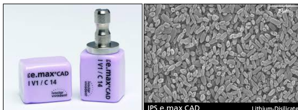
شكل 3: يوضح البنية المجهرية والشكل التجاري لخزف IPS-e.max CAD (IvoclarVivadent)
