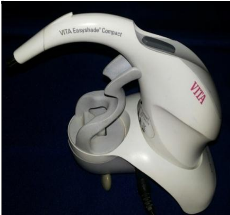
شكل 33: جهاز قياس اللون الالكتروني المستخدم
