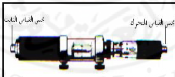
الشكل (19-1) ميكرومتر القياس الداخلي
