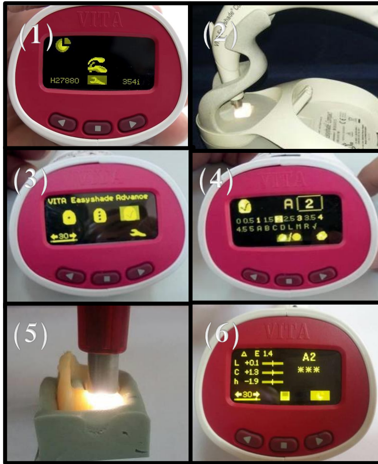
الشكل (29) : طريقة استخدام جهاز Vita EasyShade: (1) اختيار أيقونة معايرة الجهاز (2) معايرة الجهاز (3) اختيار وضع المقارنة comparison mode (4) اختيار اللون المعياري للمقارنة مع القياسات (5) قياس العينة (6) شاشة الجهاز بعد قياس اللون وحساب قيمة التغير اللوني \Delta E
