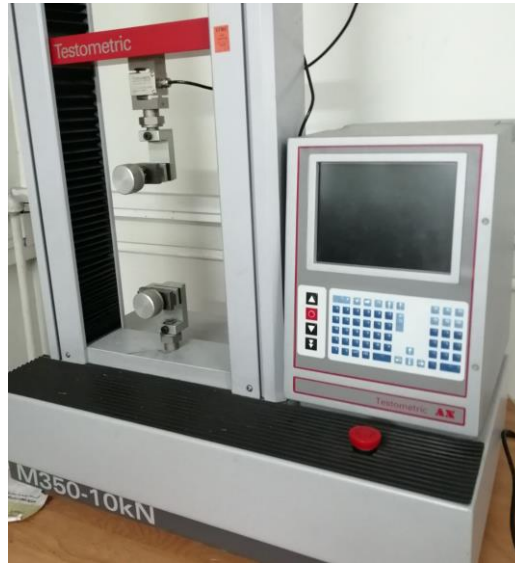
الشكل (2-4) جهاز شد الأقمشة المستخدم في الاختبارات العملية.
