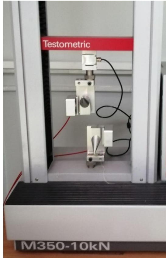
الشكل (5-1) جهاز قياس شد الخيوط Testometric M350-10KN.
