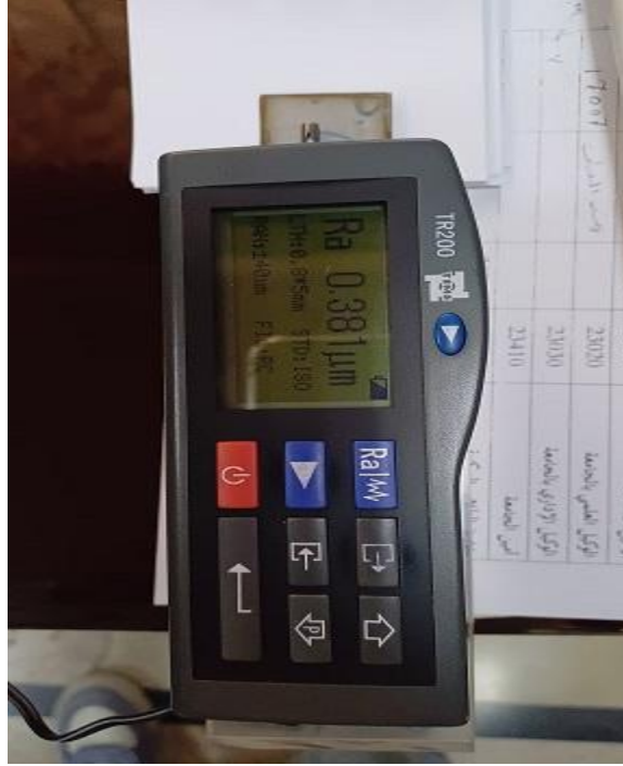
الشكل (6-7) جهاز اختبار الخشونة
