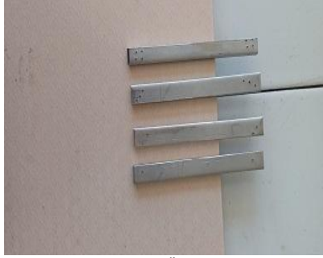
الشكل (6-13) العينات التي تم تجهيزها لاختبار التآكل الكيميائي
