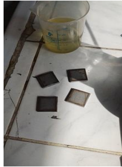
الشكل (7-3) عينات قبل التخميل وبعد التخميل
