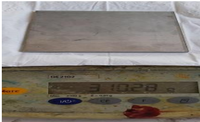
الشكل (7-7) وزن العينة رقم 1 ذات البعد (10*100) مم قبل و 3 بعد التخميل
