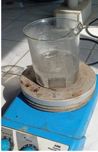
الشكل (7-2) غمر العينات بالحمض للتخميل
