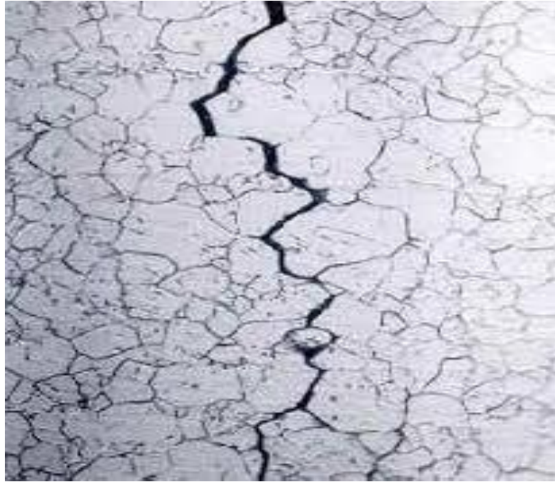
الشكل (3-7) صورة مجهرية للتآكل الإجهادي
