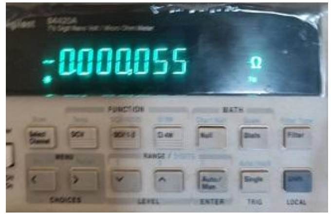
الشكل (7-9) قياس المقاومة بعد التخميل
