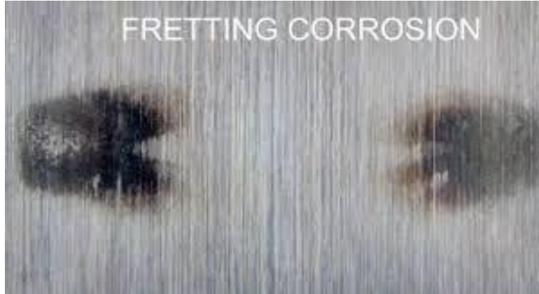
الشكل (3-19) صورة مجهرية للتآكل بالاحتكاك
