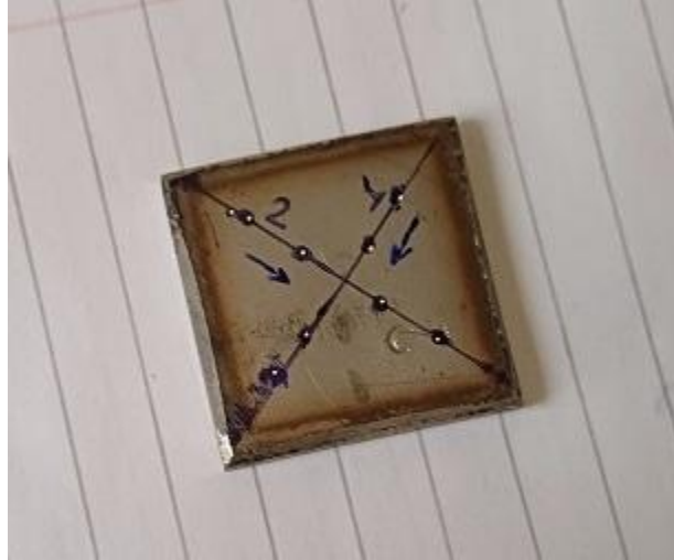
الشكل (6-8) طريقة توضع نقاط القياس على العينة
