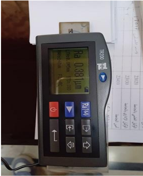
الشكل (4-7) اختبار الخشونة على العينة رقم 4 قبل التخميل وبعده
