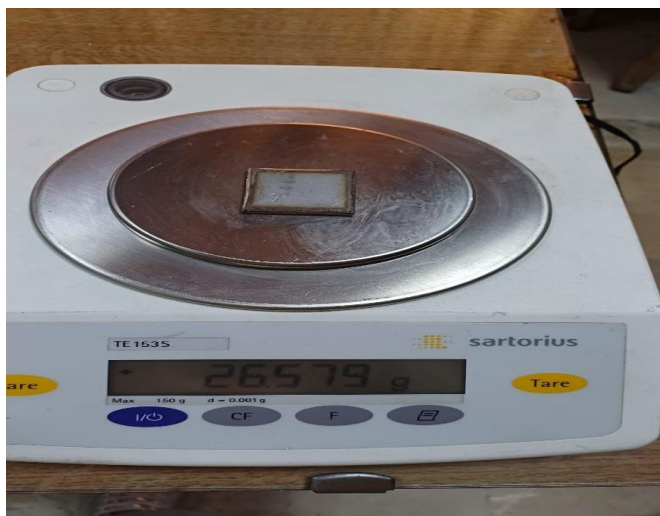
الشكل (7-6) وزن العينة رقم 2 ذات البعد (30*30) مم قبل وبعد عملية التخميل
