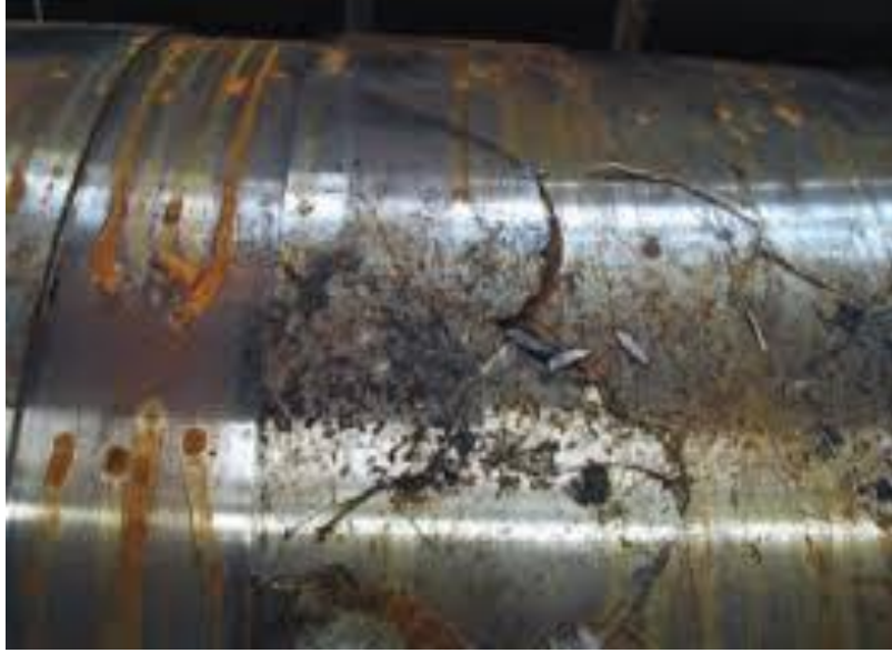
الشكل (3-16) التآكل بالهيدروجين
