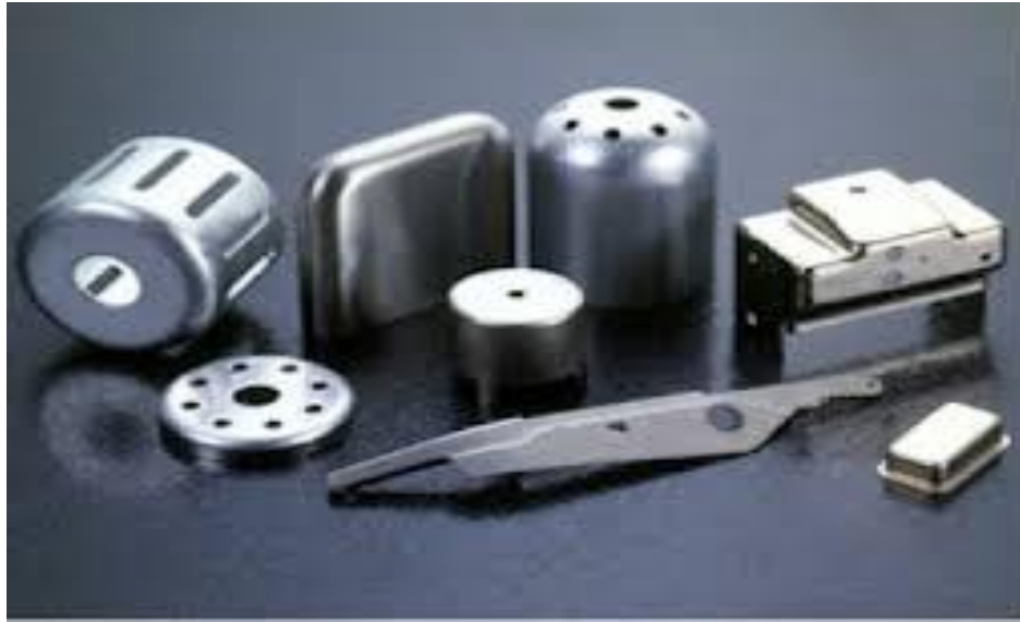
الشكل (4-8) بعض التجهيزات المخملة بالتحويل الكيميائي
