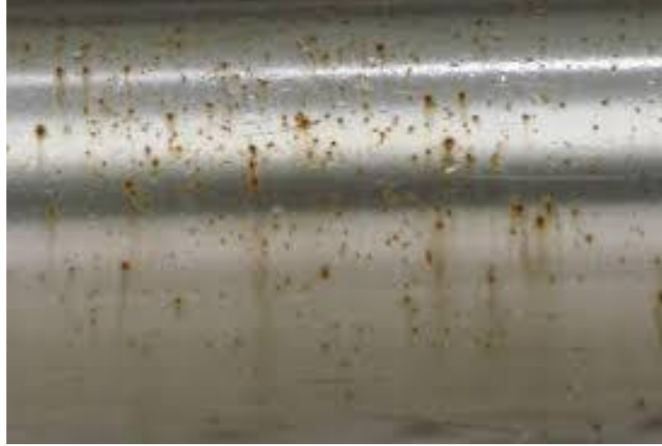
الشكل (3-14) التآكل بسبب التلوث السطحي
