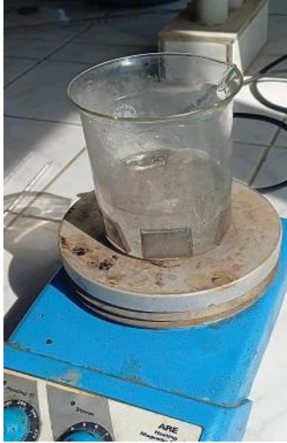
الشكل (3-6) غمر العينات بالحمض للتخميل
