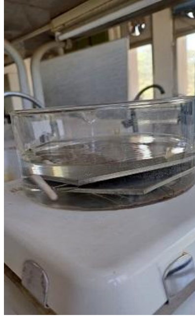
الشكل (3-6) غمر العينات بالحمض للتخميل
