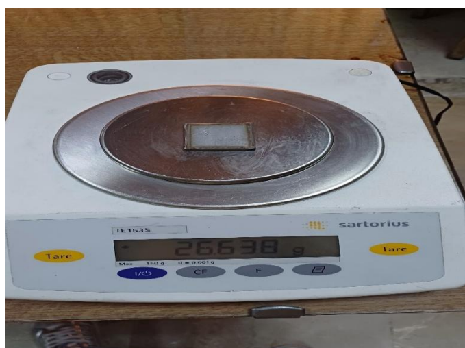
الشكل (6-5) استخدام ميزان دقيق لوزن العينات ذات البعد (30*30) مم قبل وبعد عملية التخميل
