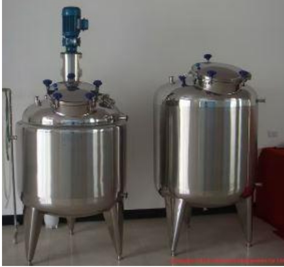
الشكل (2-4) الفولاذ المقاوم للصدأ 304
