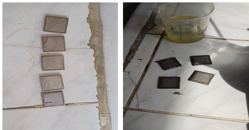
الشكل (6-4) عينات قبل التخميل وبعد التخميل
