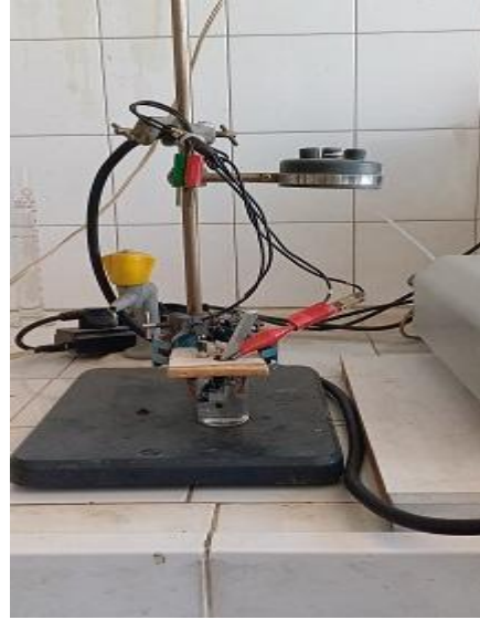
الشكل (6-14) جهاز اختبار الجهد الكهروكيميائي
