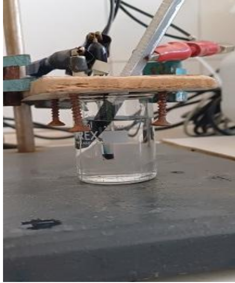
الشكل (6-14) جهاز اختبار الجهد الكهروكيميائي
