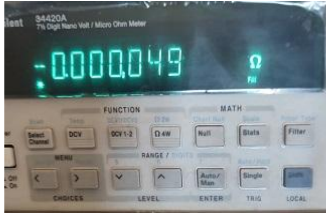
الشكل (7-9) قياس المقاومة بعد التخميل
