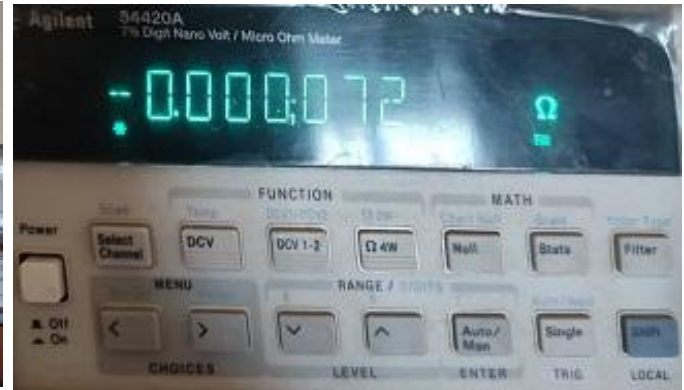
الشكل (7-8) قياس المقاومة قبل التخميل
