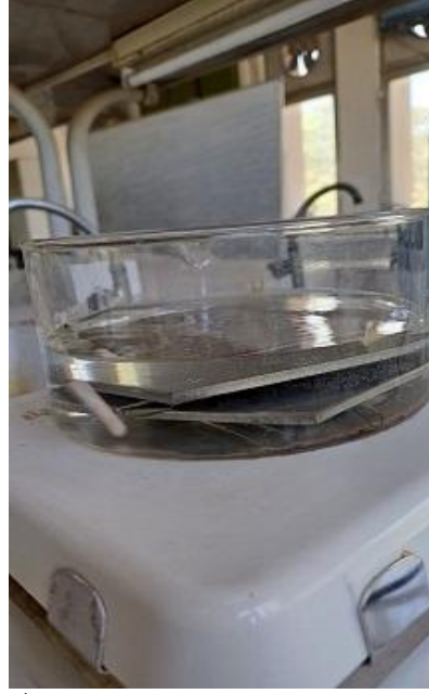
الشكل (7-2) غمر العينات بالحمض للتخميل
