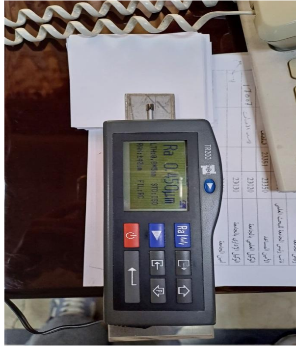
الشكل (4-7) اختبار الخشونة على العينة رقم 4 قبل التخميل وبعده
