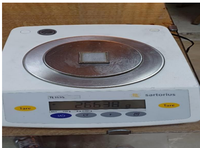
الشكل (7-6) وزن العينة رقم 2 ذات البعد (30*30) مم قبل وبعد عملية التخميل
