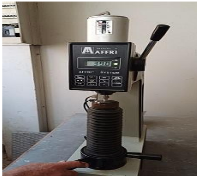
الشكل (6-9) جهاز اختبار القساوة
