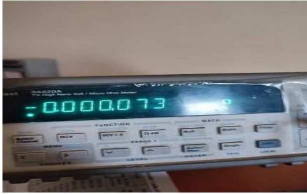
الشكل (7-8) قياس المقاومة قبل التخميل
