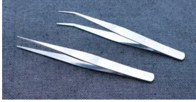
الشكل (2-5) أحد استخدامات الفولاذ المقاوم للصدأ المارتنسيدي
