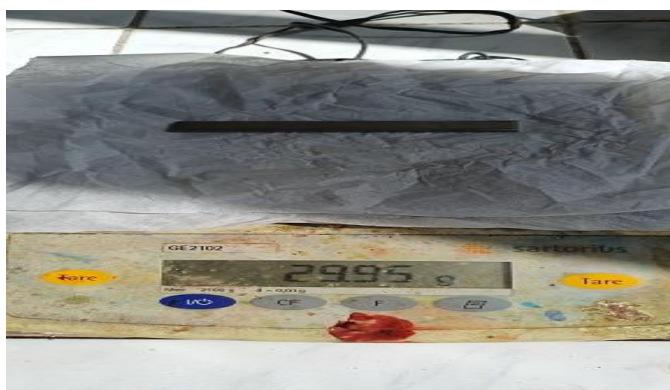
الشكل (7-6) وزن العينة رقم 2 ذات البعد (30*30) مم قبل وبعد عملية التخميل
