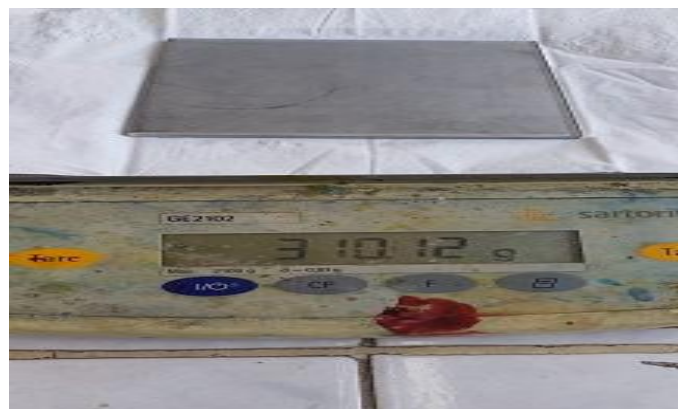
الشكل (7-7) وزن العينة رقم 1 ذات البعد (10*100) مم قبل و 3 بعد التخميل
