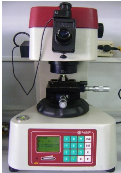
الشكل (9-2) جهاز اختبار القساوة المجهرية Galileo
