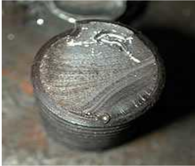
الشكل (2) الانهيار التعبى لبرغي.
