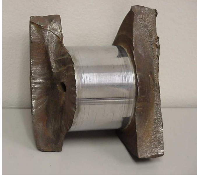
الشكل (1) الانهيار التعبى لعمود تدوير مرفقي.
