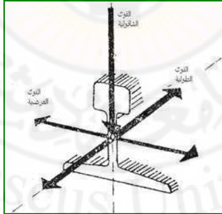
الشكل 1-6: القوى في الخط الحديدي
