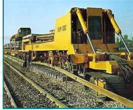
الشكل (1-8-b) آلة لإنشاء الخط الحديدي وآلة تبديل القضبان
