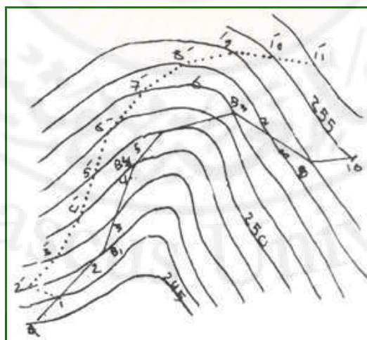
الشكل (2-4) طريقة اختيار محور الخط الحديدي استناداً إلى طريقة (خط الصفر)
