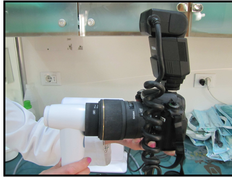
الشكل 12 : يبين طريقة وصل الجهاز VELscope بالكاميرا الرقمية المستخدمة
