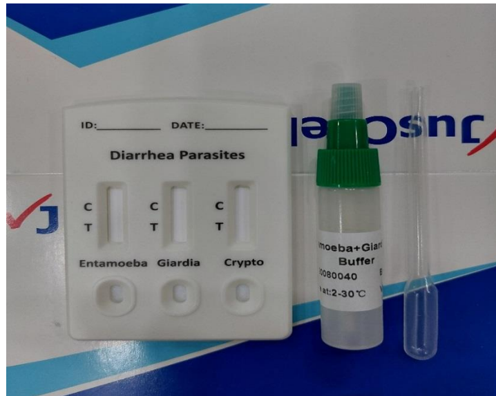
الشكل (64): مكونات اختبار الاستشراب المناعي الثلاثي JusChek
