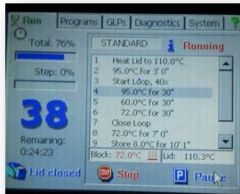
شكل (2-2) جهاز PCR والدورات الحرارية المتبعة لتحضير العياري المتواجد في مركز التقانات الحيوية
