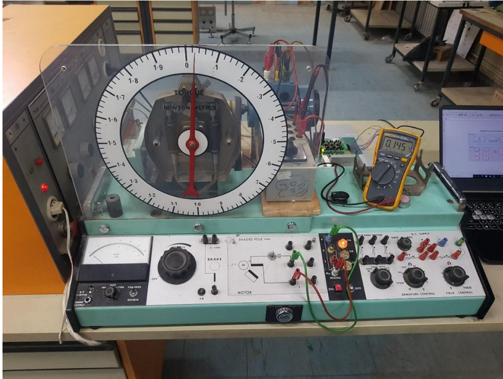
الشكل (4-31): الحمولة الميكانيكية المستخدمة - حمل ذو عزم ثابت قابل للتعبير - بالإضافة لمقياس العزم.
