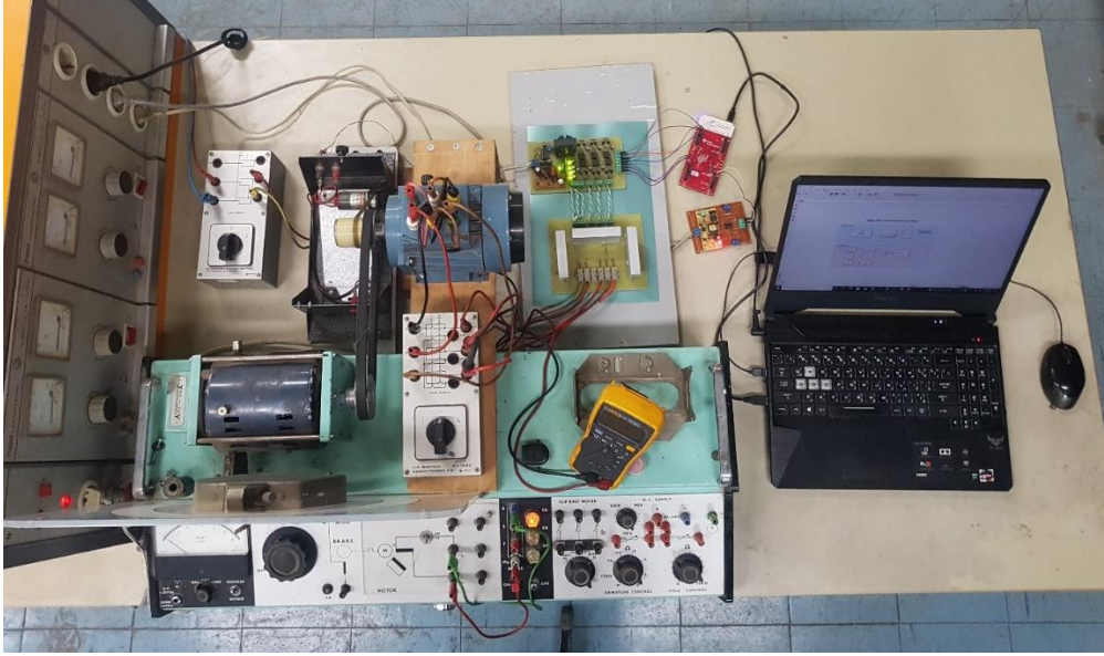
الشكل (4-30): تجربة اختبار الاستجابة الديناميكية لنظام القيادة تحت الحمل
