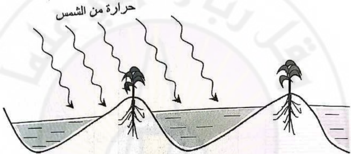
شكل (6-22): يبين كيفية زيادة الميل الجانبي للخطوط من أجل زيادة مساحة التربة المعرضة للشمس
