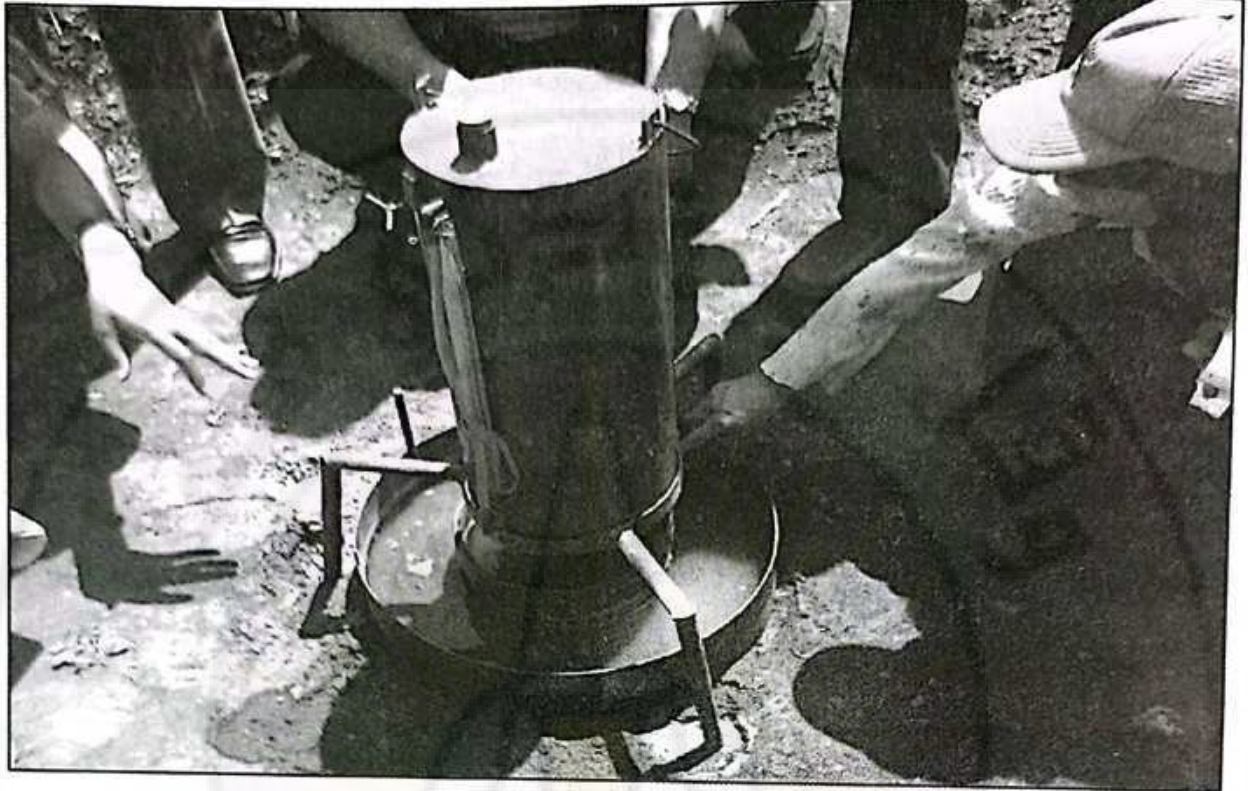
الشكل (2-8): جهاز قياس التسرب ذو الحلقة المزدوجة
