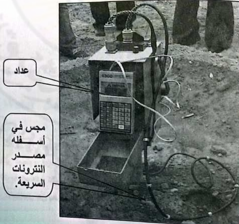
الشكل (7-29): أجزاء جهاز تشتت النيوترونات
