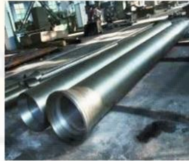
الشكل (5-10): السباكة بالطرد المركزي في قالب محور دورانه أفقي.
