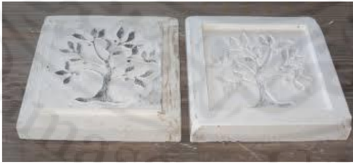
الشكل (6-6): قالب جبس جاهز للصب.
