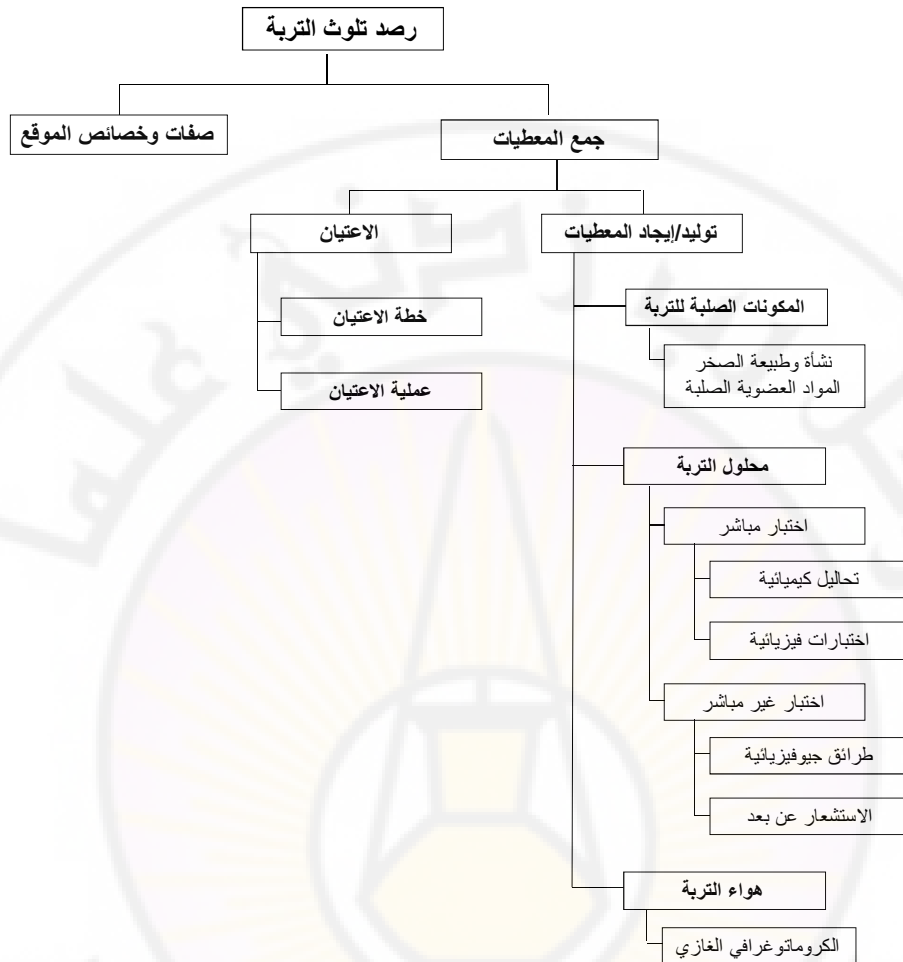
الشكل (٧٢) المراحل الرئيسية لعملية رصد تلوث التربة.
