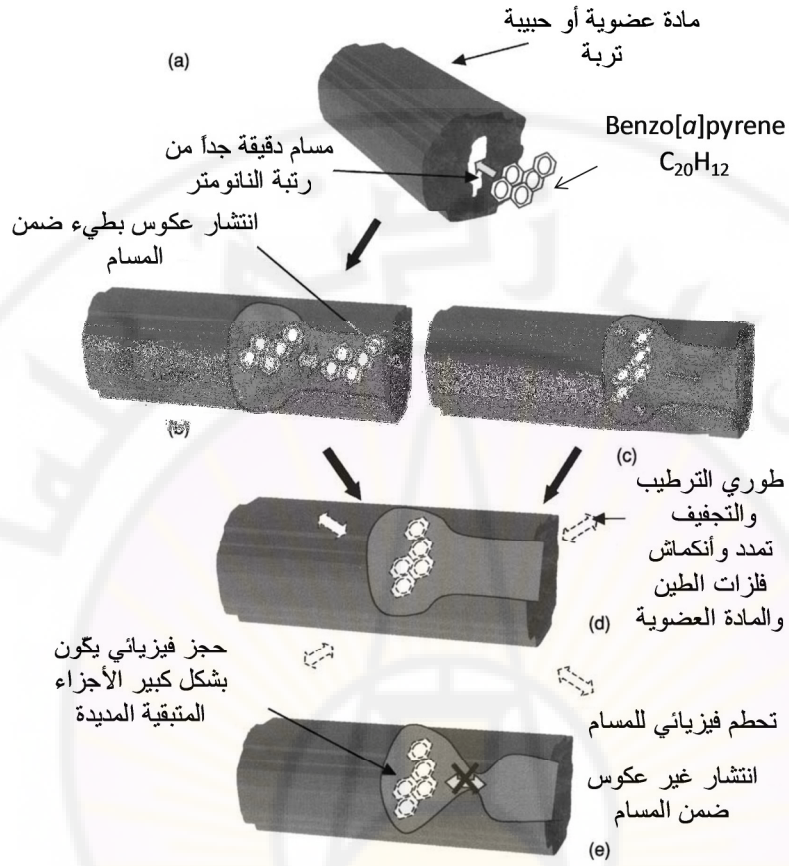
الشكل (٣٩) شكل توضيحي يبين عملية انتشار المركب benzo(a)pyrene ضمن حبيبات التربة.
