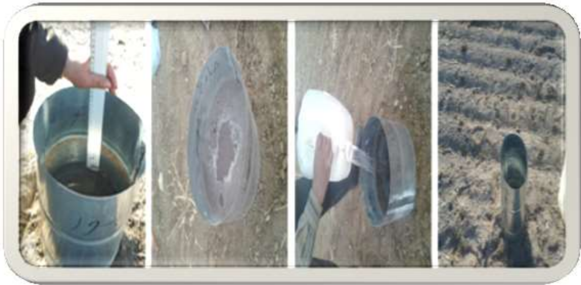
الشكل (2-7): خطوات تجربة معدل الرش
