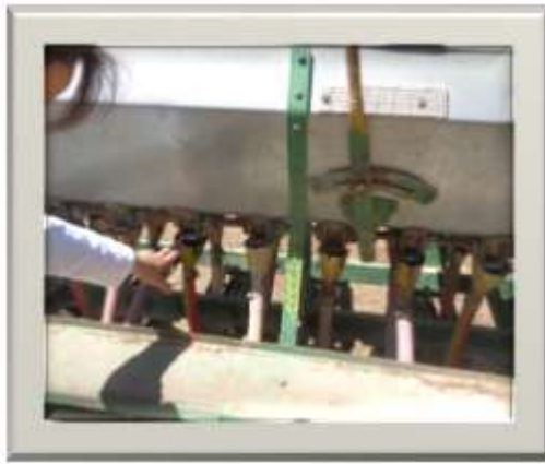
الشكل (2-4): يبين الآلة المستخدمة في الزراعة الحافظة والنوابض والأحواض المنفصلة المزودة بها الآلة
