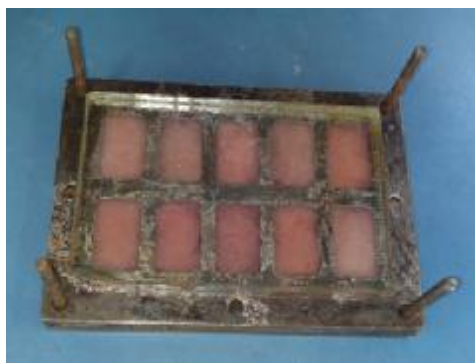
الشكل (2-16) وضع مادة التبططين ضمن القالب
