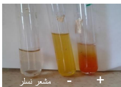
الشكل (14) اختبار لوني إيجابي واختبار سلبي لإنتاج الامونيا إضافة الى مشعر نسلر
