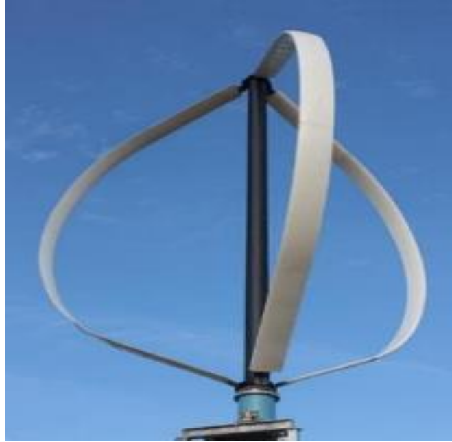
الشكل (11-2): يبين توربينات الرياح داريوس من نوع مضرب البيض
