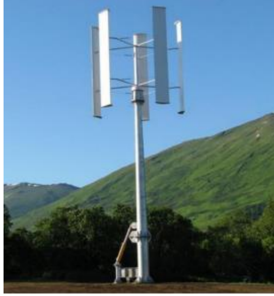
الشكل (4-2): يبين توربينات الرياح ذات المحور العمودي (VAWT)
