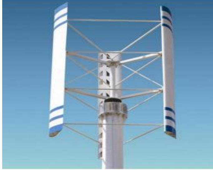
الشكل (2-12): يبين توربينات الرياح داربوس ذات الشفرات المستقيمة
