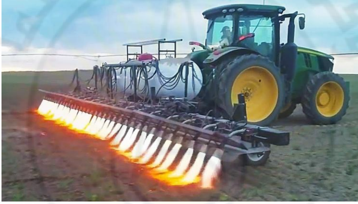
شكل (14) طريقة مكافحة الأعشاب الضارة باستخدام اللهب
