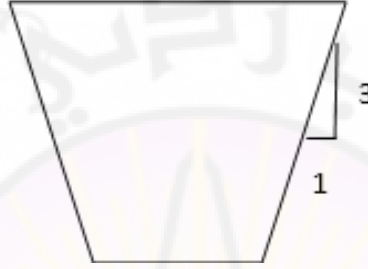
شكل (8) الميل المناسب للقنوات المائية
