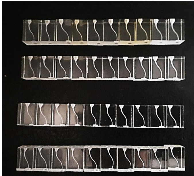
الشكل 29: القوالب الراتنجية ذات الانحناء المضاعف
