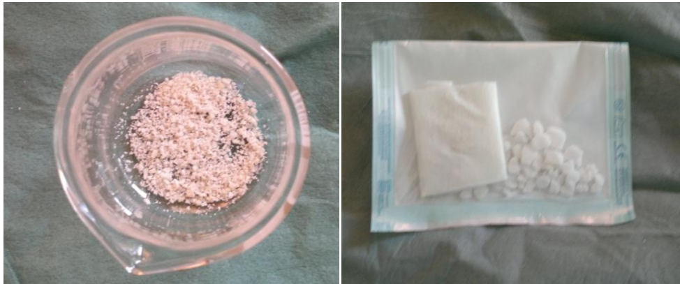
الشكل (١١) : تجفيف العينة وذلك بوضعها ضمن غلاف مسامي أو ورقة ترشيح ثم وضعها بغلاف اخر يحتوي على مادة
