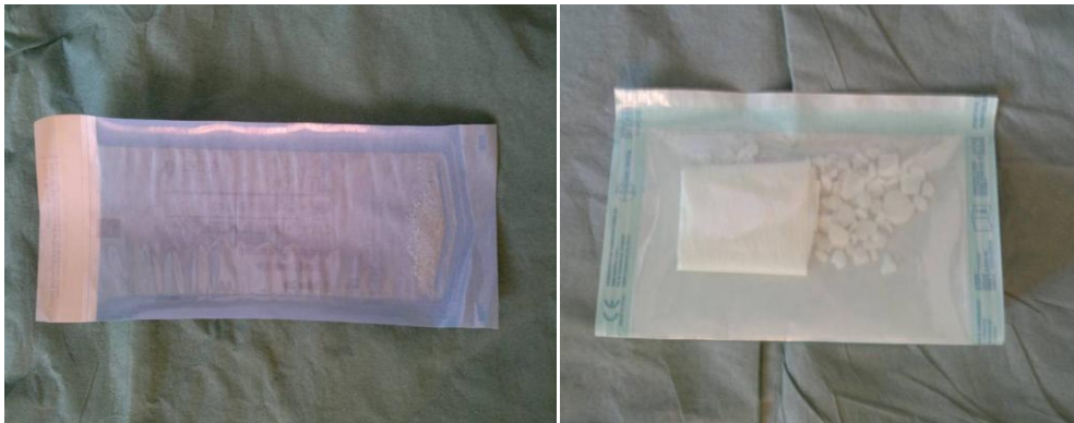
الشكل ( ١٣ ) : تجفيف العينة ثم تحضيرها للتعقيم بغاز اكسيد الايتيلين
