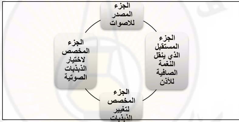
الشكل 16: أجزاء جهاز الأوديومتر
