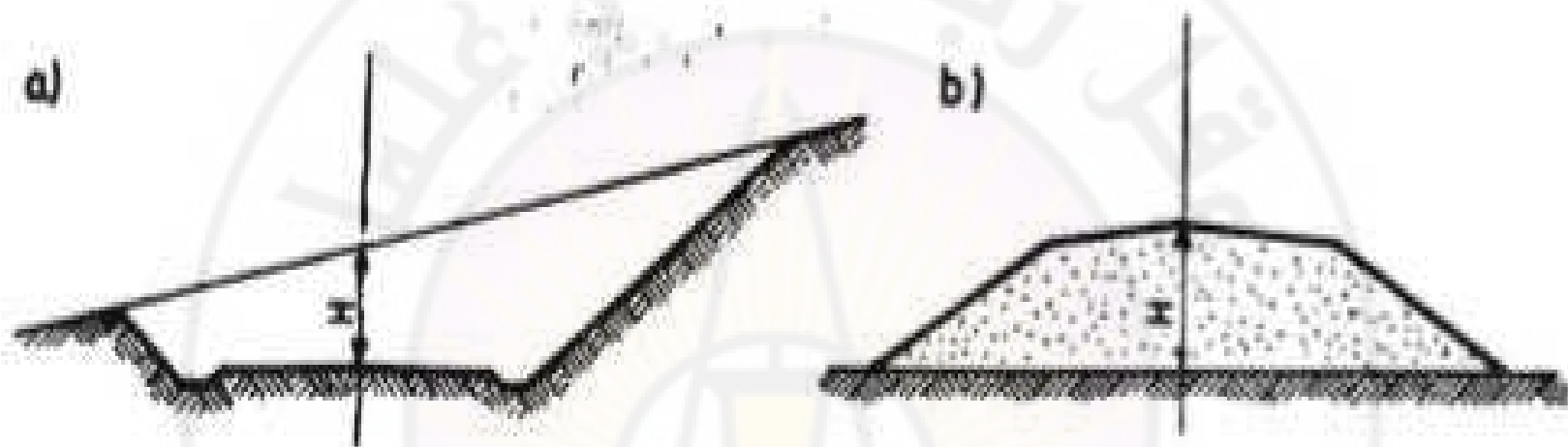
شكل ( ٥-٢ ) ارتفاع محور الطريق من الأرض الطبيعية a - في الحفر b - في الردم
