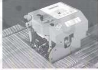
الشكل (3-4): آلة عقد (ربط) خيوط السداء (Adanur, S.,2001). (Fischer Poege) Warp tying machine
