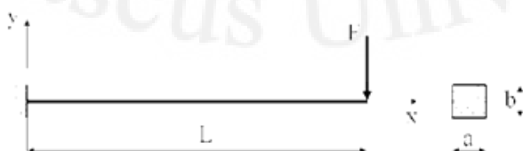
الشكل ١١-٣٩ جائر ذو مقطع مستطيل مثبت من طرف وتحمل بقوة مركزة من طرفه الحر
