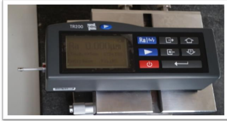
شكل 56 أداة قياس خشونة السطح TR200
