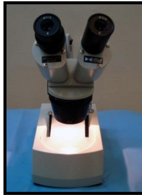
الشكل (12): المجهر المجسّم (المكبرة الضوئية) المستخدم في البحث.
