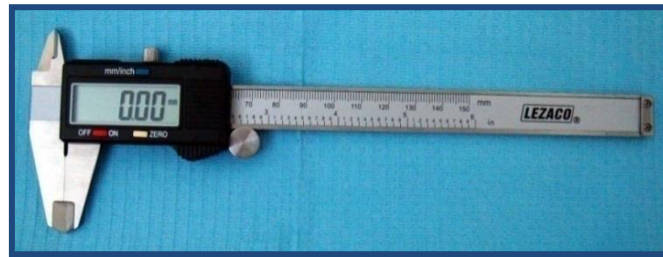
الشكل (13): مقياس الثخانة الرقمي (البياكوليس) المستعملة في البحث.
