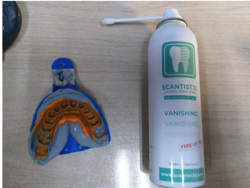
الشكل 10 بخاخ لتغطية الطبقات برذاذ خالٍ من مادة ثاني أوكسيد التيتانيوم \text{TiO}_2
