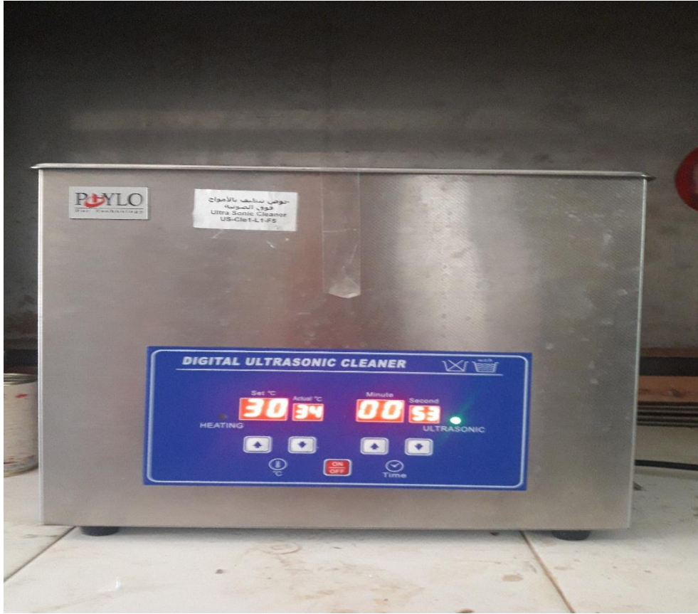
الشكل (24) جهاز التنظيف بالأمواج فوق صوتية.
