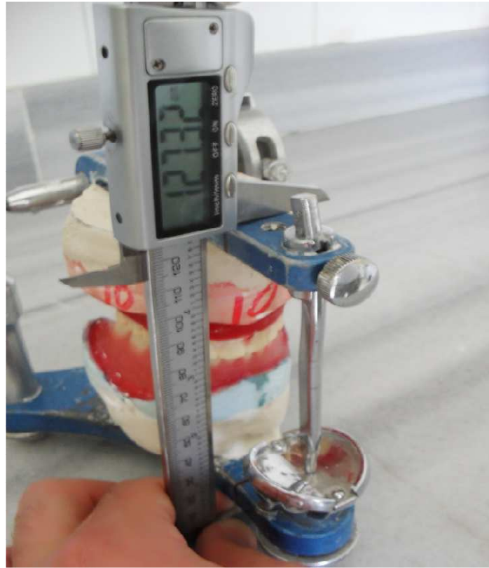
الشكل (27-2) القياس بين الساعدين الأفقيين للمطبق
