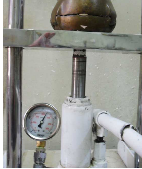
الشكل (2-35) الإغلاق النهائي للبوتقة بضغط 3500 psi
