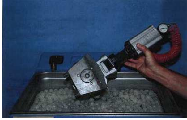
الشكل (2-41) وضع البوتقة في المحم المائي الحاوي على كريات من البلاستيك (6)
