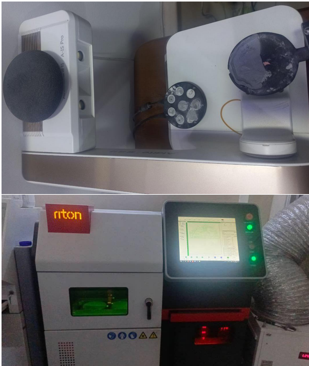
الشكل (17): الماسح ثلاثي الأبعاد (Aidite, A-15 Pro China) في الأعلى، وجهاز الإذابة بالليزر الانتقائي في الأسفل (Riton dual-150).
