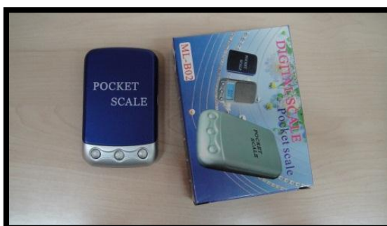
الشكل رقم (٢-٧) ميزان حساس لضبط كمية الكريمة المطبقة
