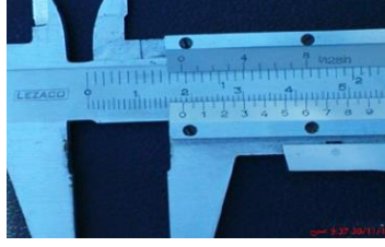
الشكل (1) : صورة توضح البياكوليس الذي تم بواسطته قياس قطر الطعم النامي .
