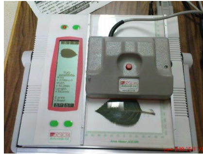
الشكل (2) : صورة لجهاز الـ (AM300) Area Meter الذي تم بواسطته قياس مساحة ورقة التفاح .
