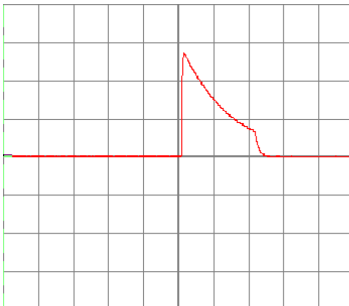
الشكل (3-19) الموجة النبضية الناتجة عند R_e=2.2\text{k}\Omega
