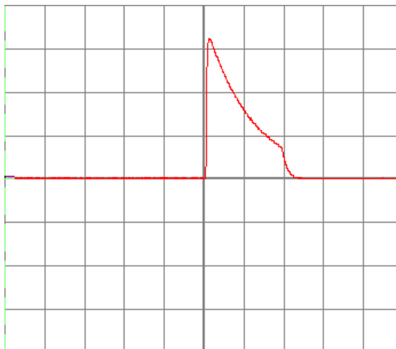
الشكل (8-3) الموجة النبضية الناتجة عند R_e=2.2\text{k}\Omega
