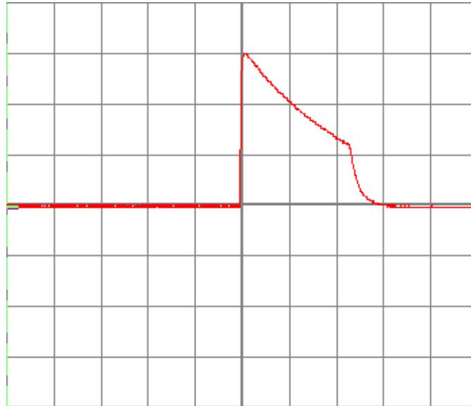
الشكل (20-3) الموجة النبضية الناتجة عند R_e=4.7 \text{ k}\Omega
