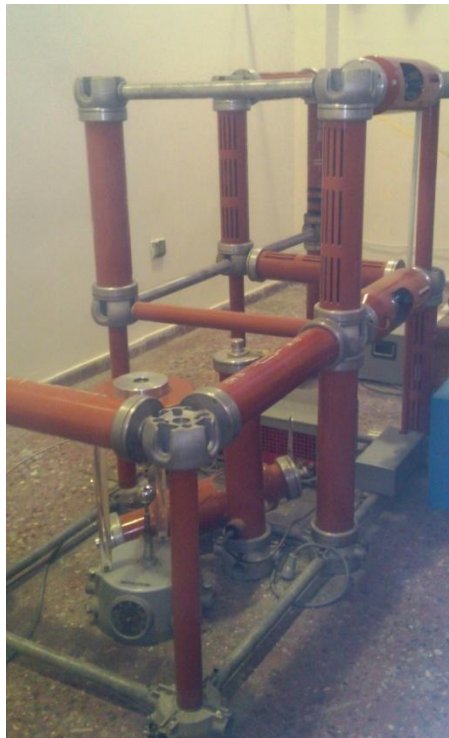
الشكل (3-30) المولد النبضي العملي الموجود في المختبر
