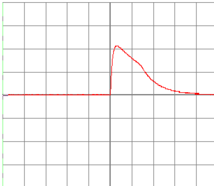
الشكل (26-3) الموجة النبضية الناتجة عند C_p=100\text{nF}
