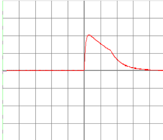
الشكل (3-28) الموجة النبضية الناتجة عند C_p=100\text{nF}
