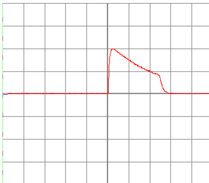
الشكل (3-16) الموجة النبضية الناتجة عند R_d=2.2 \text{ k}\Omega
