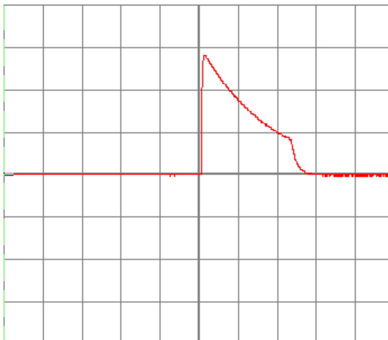
الشكل (3-15) الموجة النبضية الناتجة عند R_d=0.54 \text{ k}\Omega
