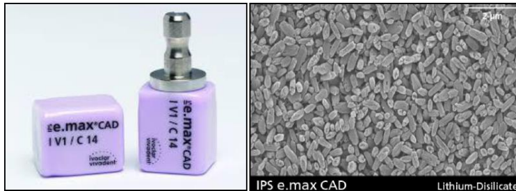
شكل 4 : البنية المجهرية والشكل التجاري لخزف IPS e.max CAD
