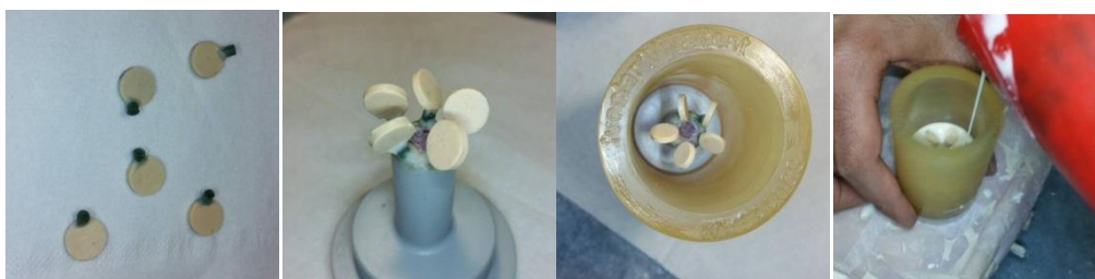
شكل 38 : توتيد النماذج الشمعية وتثبيتها ضمن البوتقة وكسيها
