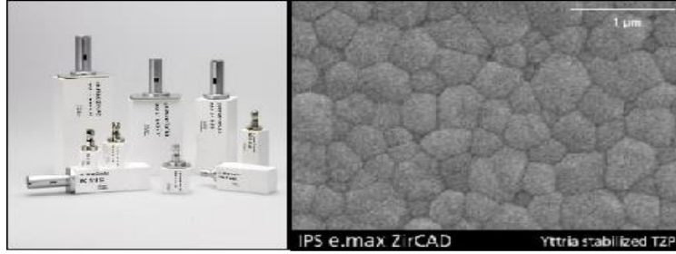
شكل 5 : البنية المجهرية والشكل التجاري لخزف IPS e.max ZirCAD
