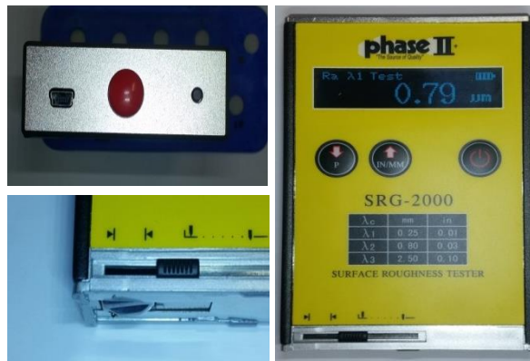
شكل 36 : جهاز قياس خشونة السطح Profilometer
