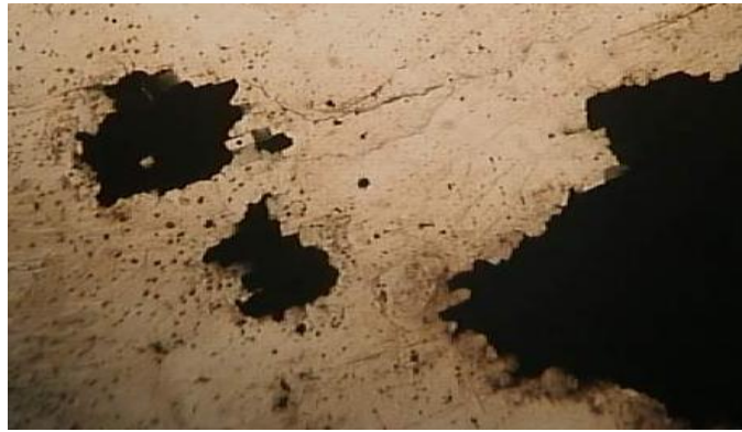
الشكل (29.5): البنية المجهرية للعينة المعالجة عند درجة حرارة 850^{\circ}\text{C} لمدة 4 ساعات وبعد غمرها بالمحول الآكال (Ringer) (50X).
