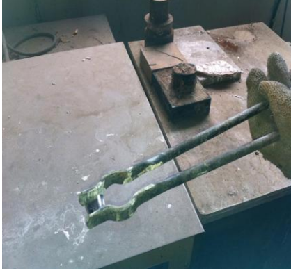
الشكل (34.4): وضع العينات داخل الفرن عند درجة 1220°C
