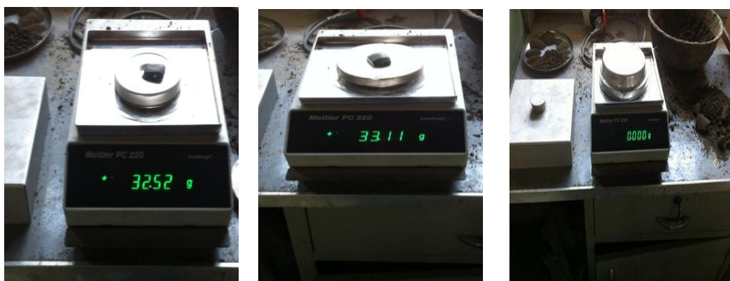
الشكل (36.4): ميزان ذو حساسية عالية وكيفية قياس وزن العينات قبل وبعد غمرها في المحلول الآكال رينغر
