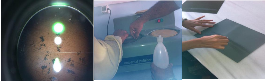
الشكل (5.4): تحضير العينات قبل وضعها تحت المجهر الضوئي.
