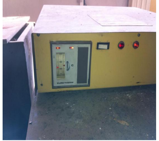
الشكل (35.4): وضع العينات داخل فرن المعالجة الحرارية عند 850°C
