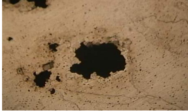
الشكل (28.5): البنية المجهرية للعينة المعالجة عند درجة حرارة 850^{\circ}\text{C} لمدة ساعتين وبعد غمرها بالمحول الآكال (Ringer) (50X).
