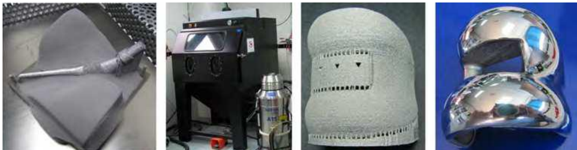
الشكل (15.3): يظهر اجزاء الفخذ بعد خروجها من جهاز حزمة الكترونات الصهر و إجراء عليها عملية التلميع.
