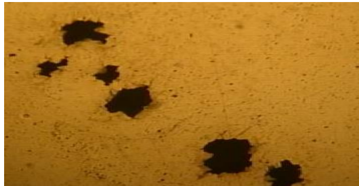
الشكل (30.5): البنية المجهرية للعينة المعالجة عند درجة حرارة 850^{\circ}\text{C} لمدة 6 ساعات وبعد غمرها بالمحول الآكال (Ringer) (50X).
