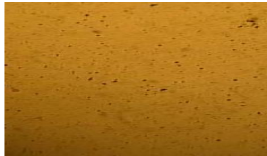
الشكل (27.5): البنية المجهرية للعينة المعالجة بدرجة حرارة 1220^{\circ}\text{C} لمدة ساعتين وبعد غمرها بالمحول الآكال (Ringer) (50 X).
