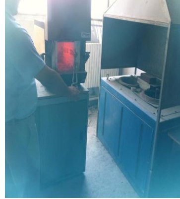
الشكل (34.4): وضع العينات داخل الفرن عند درجة 1220°C
