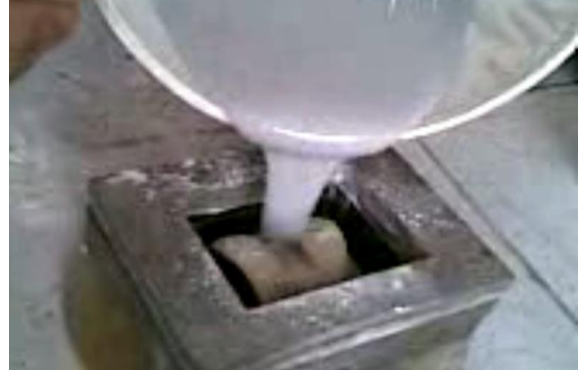
الشكل (7.4): صب السيلكون فوق النموذج المعدني وترك السيلكون حتى يجف.
