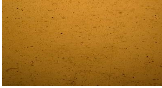
الشكل (25.5): البنية المجهرية للعينة المعالجة بدرجة حرارة 1220^{\circ}\text{C} لمدة نصف ساعة وبعد غمرها بالمحول الآكال (Ringer) (50X).
