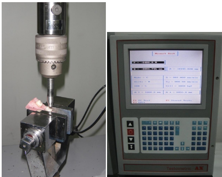
الشّكل (41): اختبار العينات بواسطة جهاز Testometric AX
