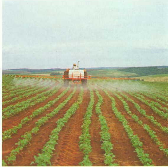
مرش محمول على عجلات مقطور خلف الجرار يحتوي على خزان واحد لمحلول الرش وحامل لعدد من المبعثرات.
