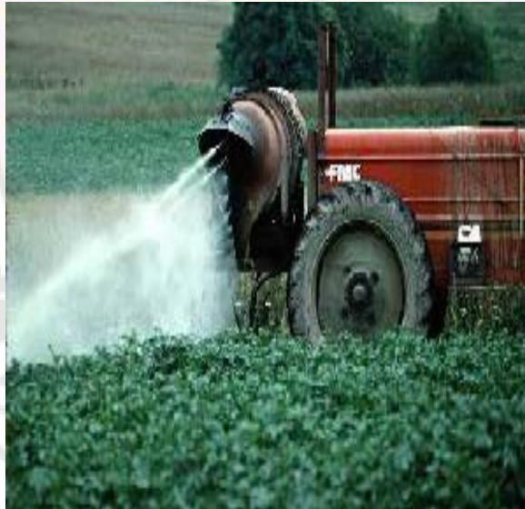
مرش محمول على الجرار يعمل بواسطة مروحة تدفع تياراً من الهواء بقوة ويحمل معه قطرات محلول الرش باتجاه المجموع الخضري للنباتات.
