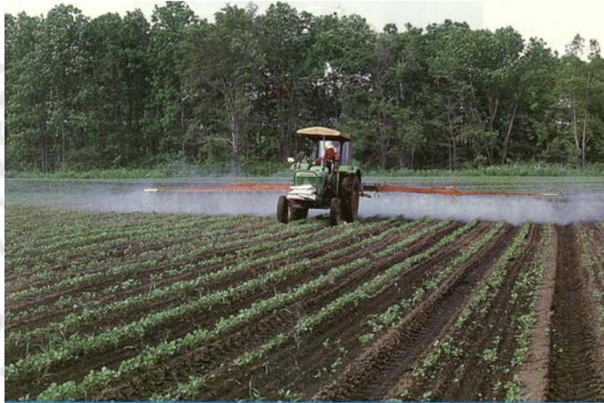
مرش محمول على عجلات مقطور خلف الجرار يحتوي على خزان واحد لمحلول الرش وحامل لعدد من المبعثرات.
