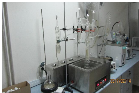
ج. جهاز سوكلست (مكثف، حجرة سوكلست، دورق يحوي على المذيب العضوي)
