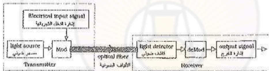
الشكل (٩-١) نظام اتصال بصري مبسط.
