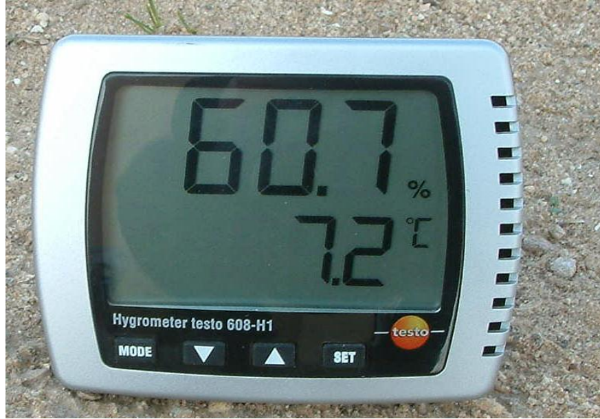
شكل رقم (٤) مقياس تقدير الحرارة والرطوبة الجوية المحلية
